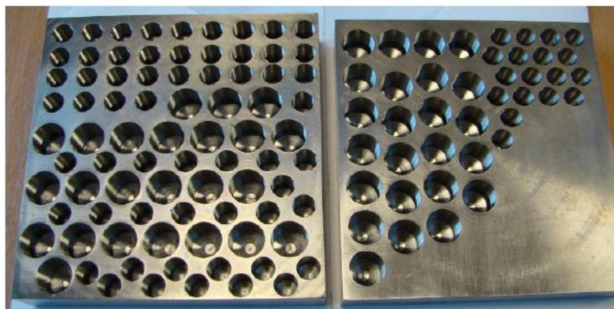
**Figura 5 – Corpo de prova com todos os furos e roscas**
