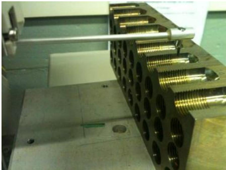
**Figura 7 - Perfilômetro para coletar os dados**
