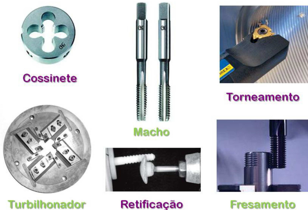
Figura 5: Diferentes processos e ferramentas de rosqueamento (Souza, 2010)
