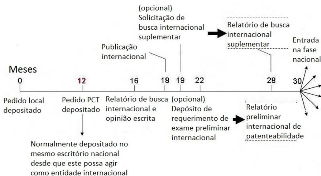
Figura 2.1 – Trâmite do processamento de um pedido PCT.
