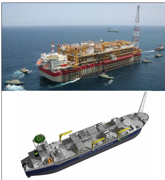
Figura 1. FPSO Barcaça ou Nova Construção (New Built) x FPSO convertido a partir de um navio. Fontes [3] e [4].
