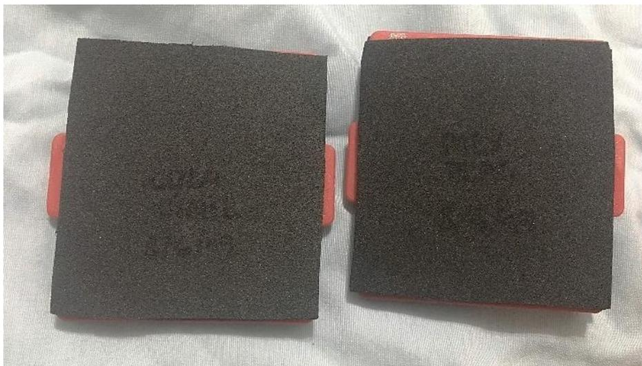
Figura 44 – Colagem teste para estruturação (EVA+PEAD+EVA, todos de 3 mm)
