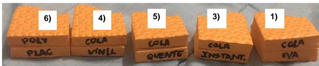
Figura 47 – Testes de colagem
