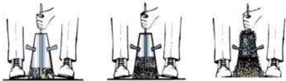
Figura 130: Passo a passo do Slump Test – 3 camadas do material
