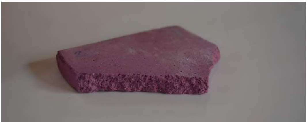
Figura 124: parte interior do concreto com adição do corante líquido. Fonte: elaboração própria
