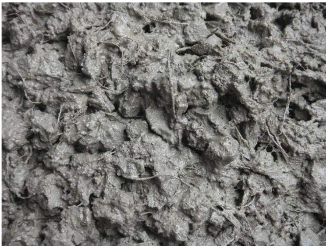
Figura 135: Fibra de polipropileno misturado ao concreto. Fonte: < http://www.neomatex.com.br/concreto-fibras-polipropileno >
