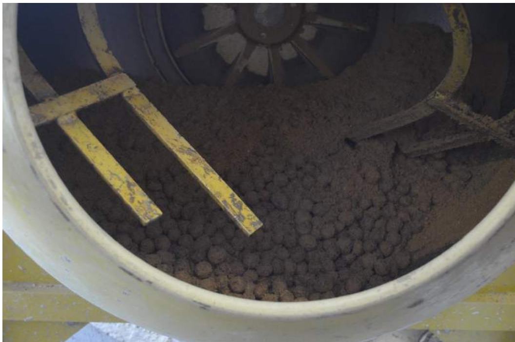
Figura 143: Mistura da argila expandida com areia molhada. Fonte: elaboração própria.
