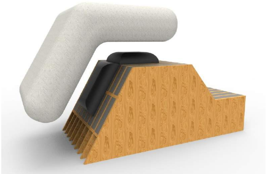
Figura 165: O molde sendo colocado na fôrma. Fonte: elaboração própria.
