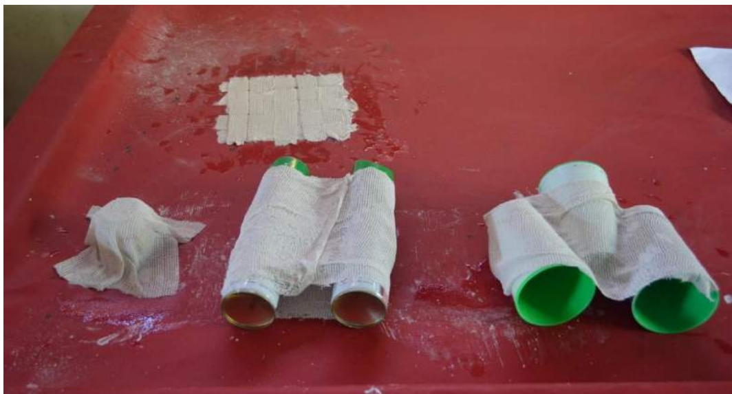
Figura 75: Fabricação dos modelos com atadura de gesso. Fonte: Elaboração própria.
