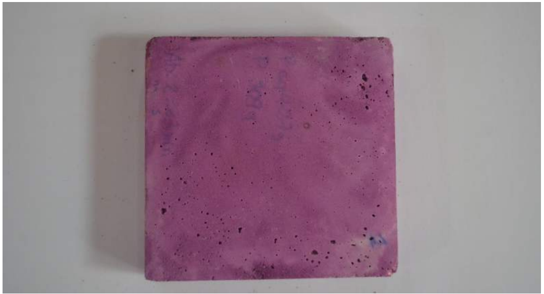
Figura 123: Amostra com o pigmento líquido. Fonte: elaboração própria
