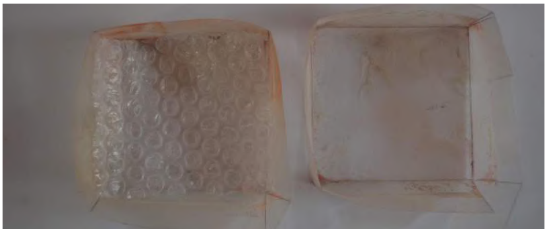
Figura 118: Molde para receber o concreto. Fonte: elaboração própria
