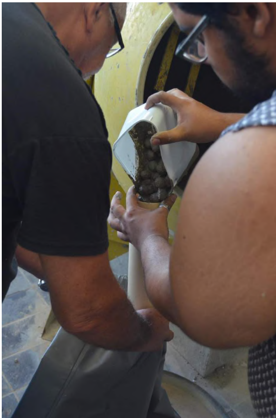
Figura 148: Colocando o concreto no molde. Fonte: elaboração própria.
