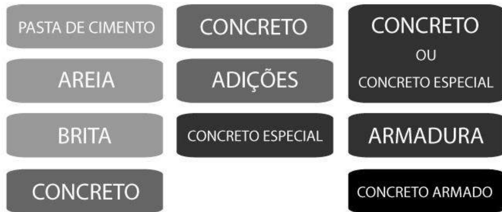
Figura 116: Esquemático da fabricação do concreto. Fonte: elaboração própria
