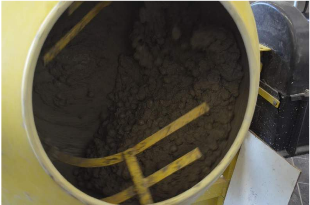
Figura 147: Mistura da argila expandida com areia molhada. Fonte: elaboração própria.
