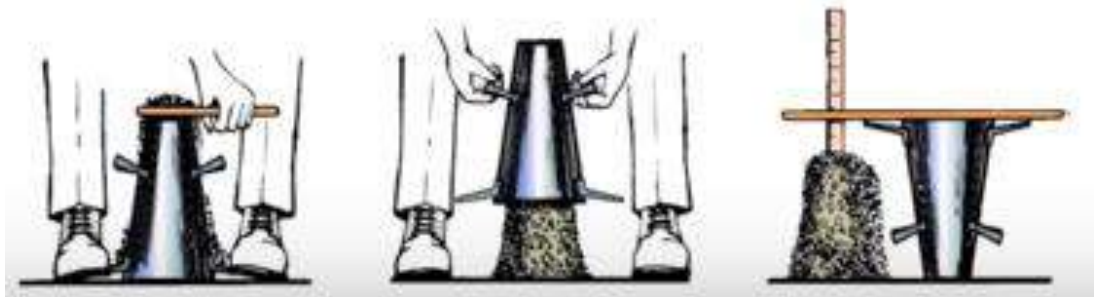
Figura 131: Passo a passo do Slump Test – retirado do cone e medição.
