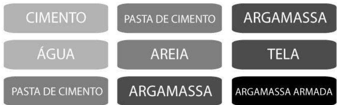
Figura 115: Esquemático da fabricação da argamassa. Fonte: elaboração própria
