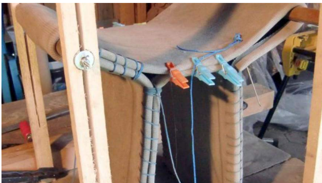
Figura 78: Fabricação da Stitching Concrete Fonte: < http://florian-schmid.com >
