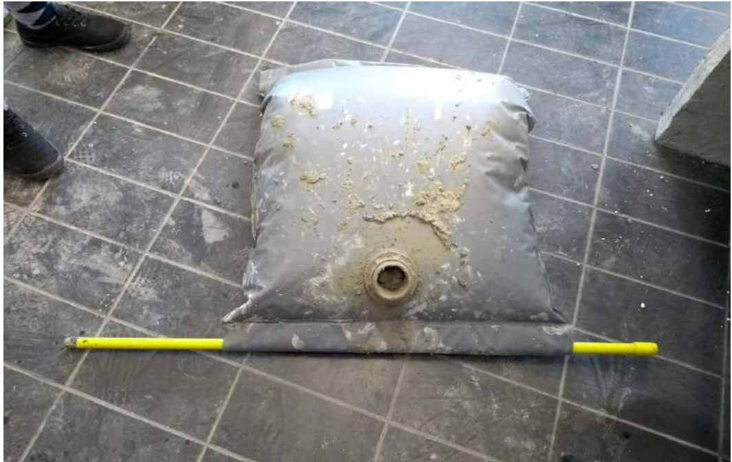
Figura 149: Molde cheio com os 45L de concreto leve. Fonte: elaboração própria.
