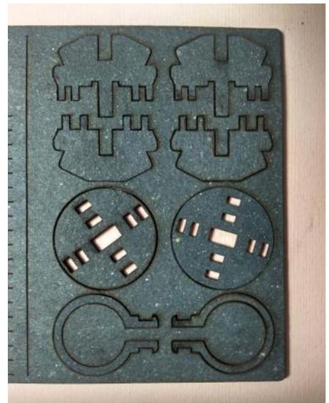
Figura 110 - Detalhe partes anel de formatura modelo feito em Cartão paraná preto 2mm cortado a laser fonte: Elaborado pelo autor
