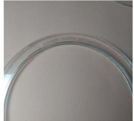
Figura 99 - Detalhe teste de gravação modelo feito em crílico cristal 2mm cortado a laser
