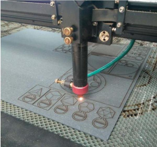
Figura 123 - Corte a laser dos testes em paraná preto
