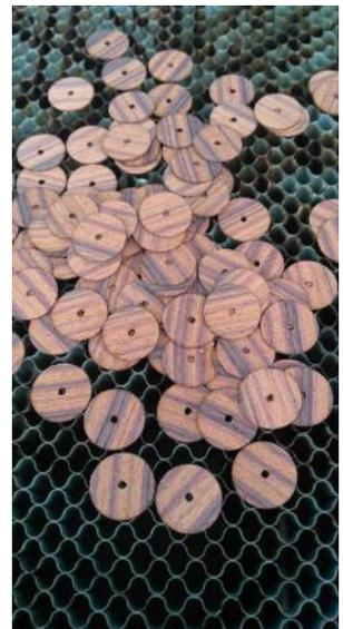
Figura 72 - Teste de corte Teste em folha de madeira pré composta fonte:Elaborado pelo autor
