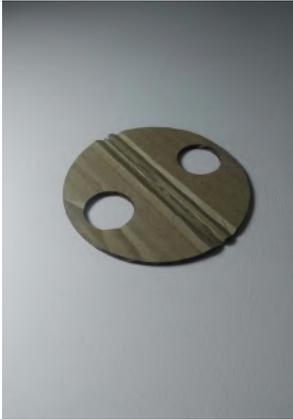
Figura 87 - Anel planificado modelo feito em papelão cortado a laser fonte: Elaborado pelo autor
