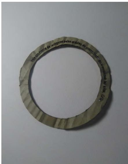
Figura 94 - Fragilidade e gravação a laser modelo feito em papelão cortado a laser fonte: Elaborado pelo autor
