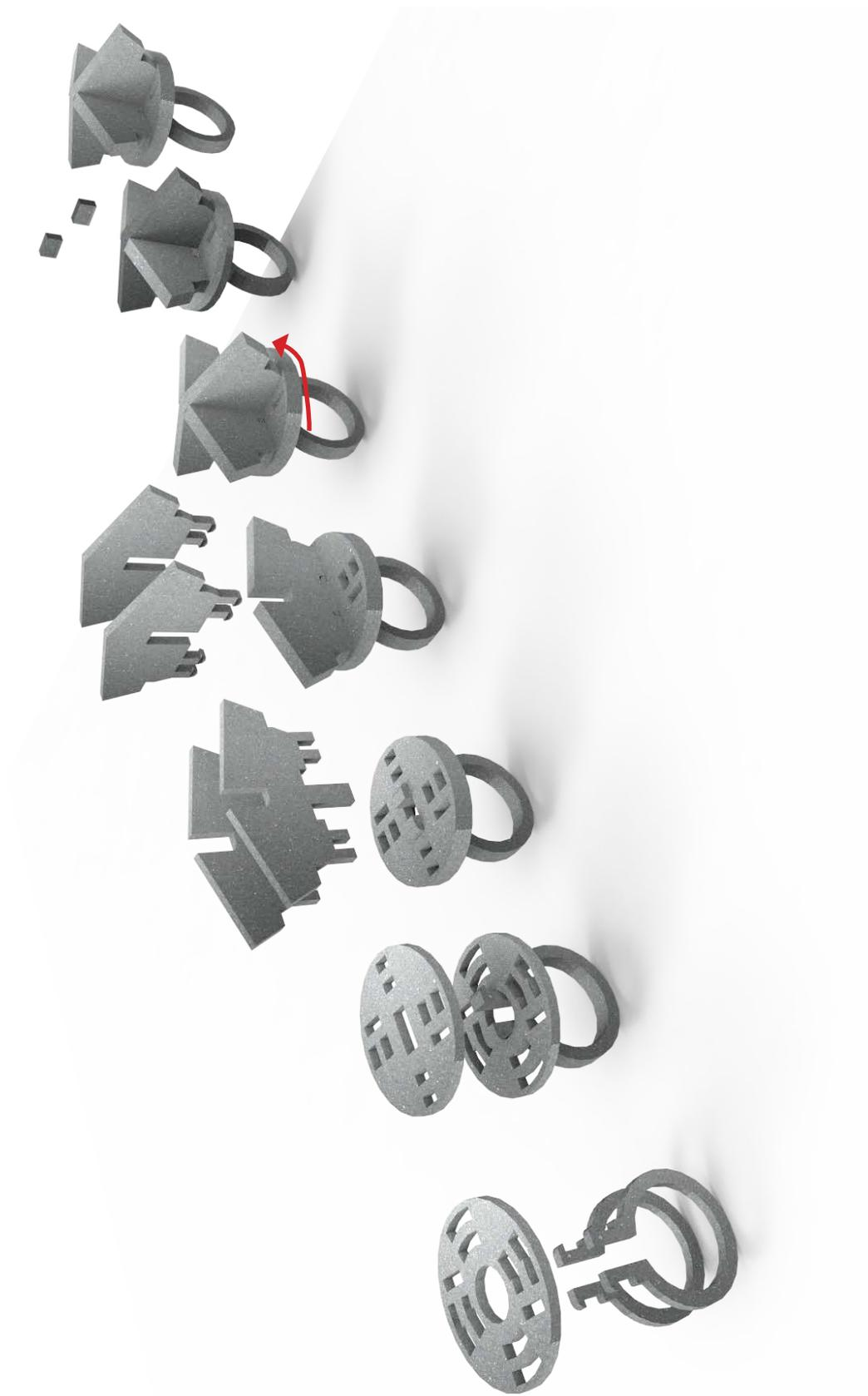
Figura 148 - Esquema de montagem e fixação do anel
