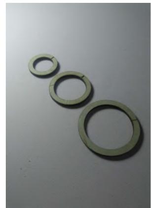
Figura 82 - Módulos modelo feito em MDF 2mm cortado a laser fonte: Elaborado pelo autor
