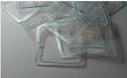
Figura 78 - Modelo de teste 2 modelo feito em clico cristal 2mm cortado a laser fonte: Elaborado pelo autor
