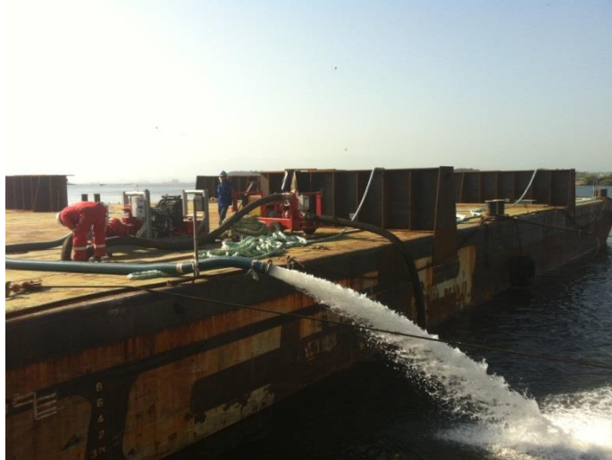
Figura 14 - Balsa Realizando Deslastro –Operação de Load Out
