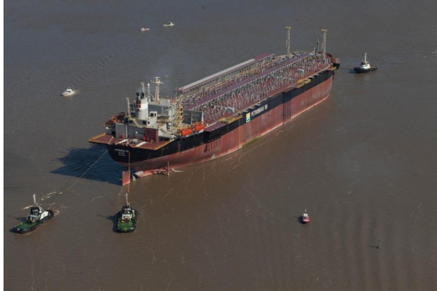
Figura 2 - Foto do Casco da P-58 sendo rebocada para a fase de acabamento
