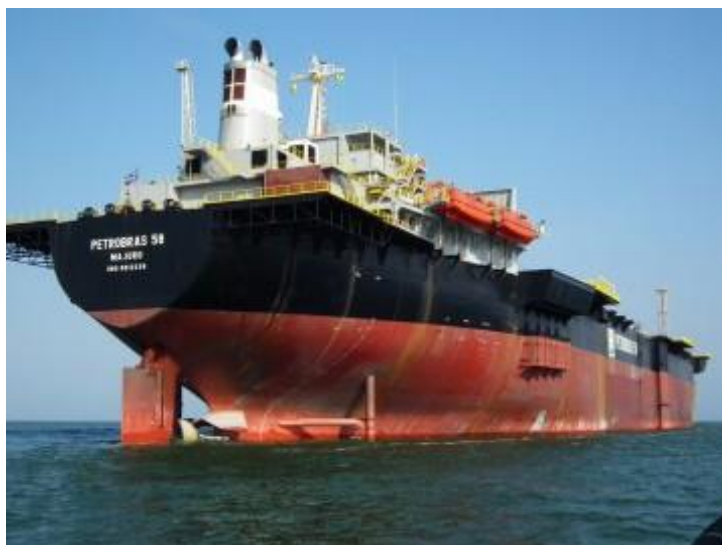
Figura 1 - Foto do Casco da P-58 ainda sem os módulos sobre o convés principal
