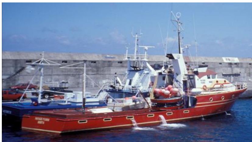
Figura 1.1. Navio em operação de deslastro
