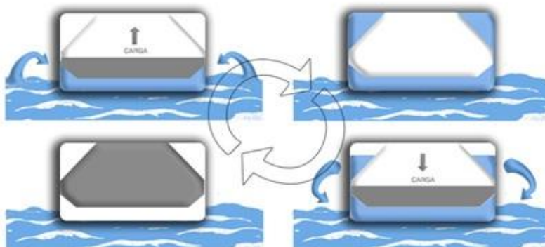
Figura 2.2. Representação do funcionamento de um sistema de lastro
