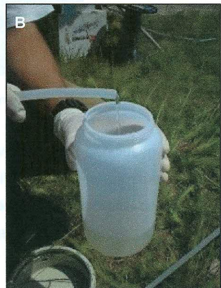
Figura 10 – Execução de amostragem com bomba de baixa vazão: A – equipamento em uso. A bomba é ligada a um conversor que possibilita a regulação da vazão. É utilizada uma mangueira de polifilo para cada poço, impedindo a contaminação. B – amostra sendo coletada com baixa vazão.
