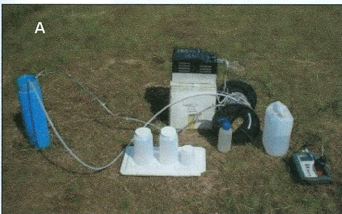
Figura 10 – Execução de amostragem com bomba de baixa vazão: A – equipamento em uso. A bomba é ligada a um conversor que possibilita a regulação da vazão. É utilizada uma mangueira de polifilo para cada poço, impedindo a contaminação. B – amostra sendo coletada com baixa vazão.
