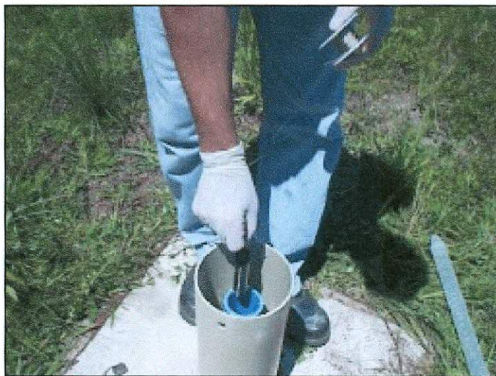
Figura 14 – Medidor de nível automático utilizado para o monitoramento da carga hidráulica nos poços PZ-17, PZ-18 e PM-04A e no canal artificial.
