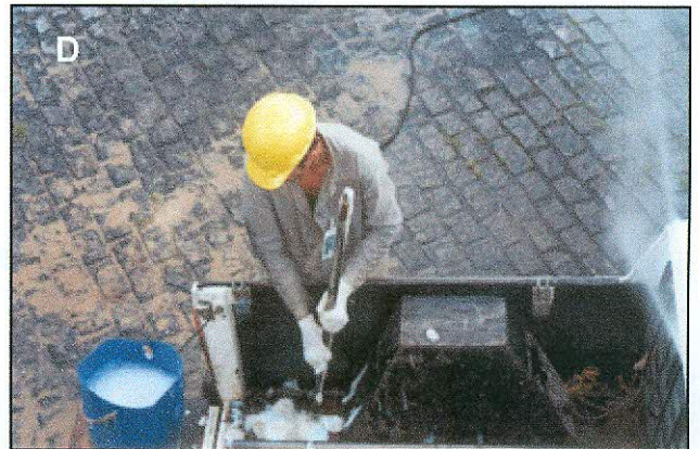
Figura 5 – Sondagem direct push : A – sonda montada sobre esteira (modelo GEOPROBE 54 DT) executando perfuração; B – amostra acondicionada em liner (camisa plástica) de PVC sendo retirada do amostrador de aço inoxidável; C – amostras identificadas segundo localização do furo e profundidade de amostragem; D – limpeza das ferramentas utilizadas com detergente especial para evitar contaminação cruzada entre sondagens.
