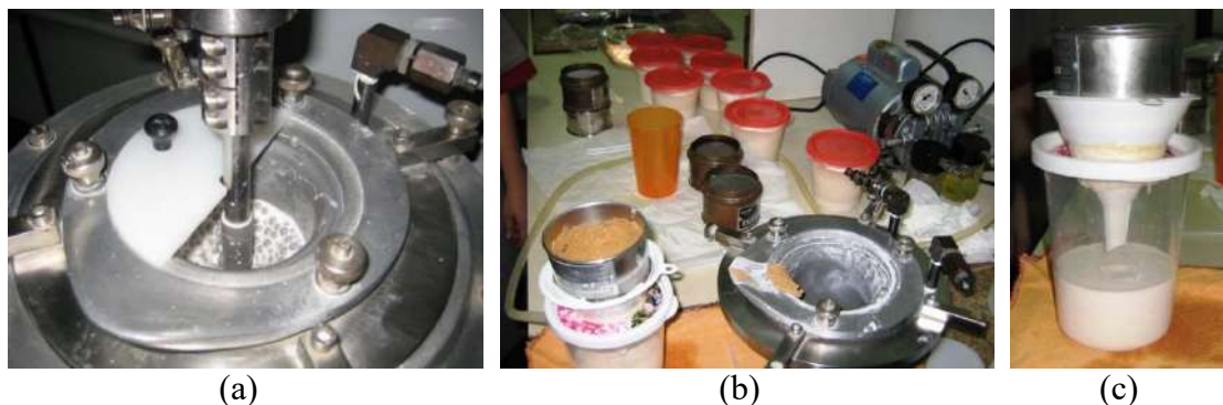
Figura IV-7. Moagem do quartzo com cargas moedoras de nitreto de silício de 5 mm (Primeira etapa) (a), Separação das cargas moedoras de zirconox da polpa (termino da segunda etapa) (b) e quartzo ultrafina após de 600 minutos de cominuição (c)
