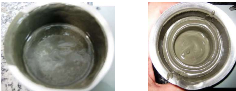
Figura IV-18. Pasta sem presença de anel de gelificação (P-REF) (esquerda) e com o anel de gelificação (P-NS) (direita)
