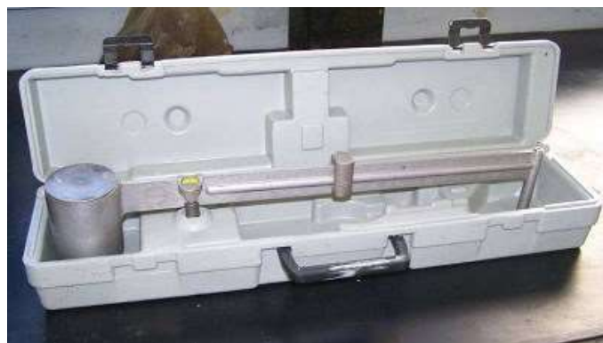
Figura III-8. Balança de lama utilizada na determinação da massa específica aparente
