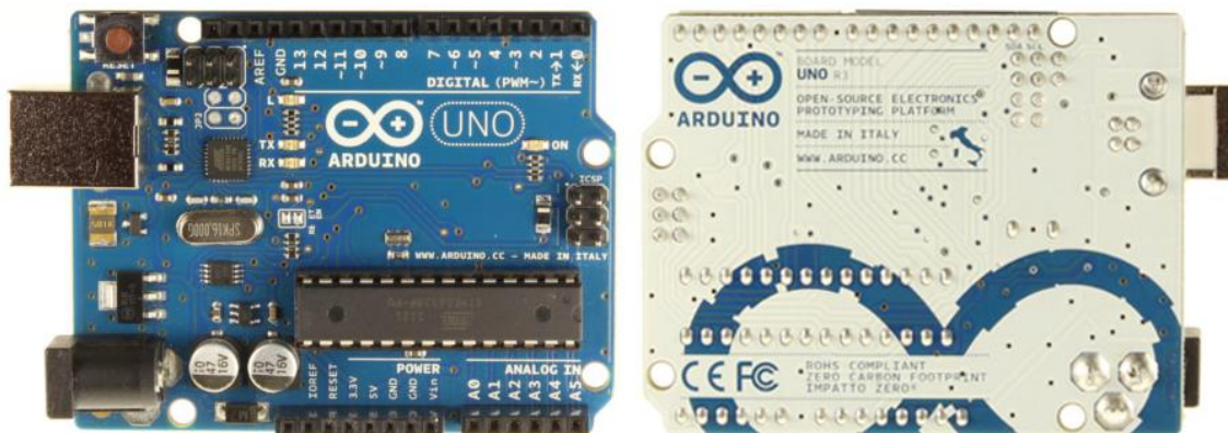
Figura 5.1: Placa Arduino Uno. Fonte: Arduino [27].
