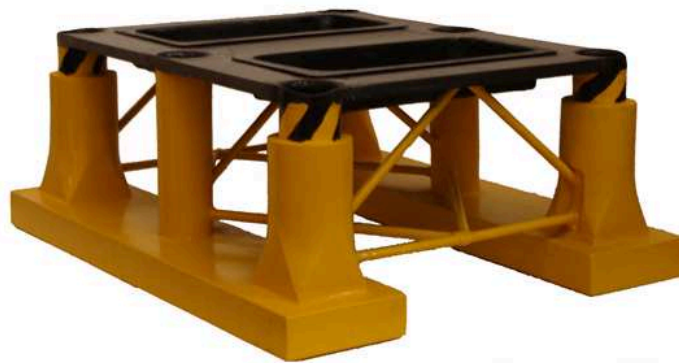
Figura 6.3: Unidade flutuante da plataforma (perspectiva).
