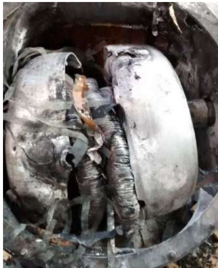
Figura 2.6 - Exemplo do efeito de uma falha interna em um TC de alta tensão Fonte: Acervo do CEPEL
