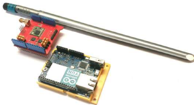
Figura 4.3: Protótipo experimental da unidade receptora. Em ordem descendente, o módulo LoRa, a placa Arduino Yún. A antena corresponde à implementada no módulo LoRa, por meio de um conector SMA ( SubMiniature version A ). A antena aparece desconectada por motivo da imagem.
