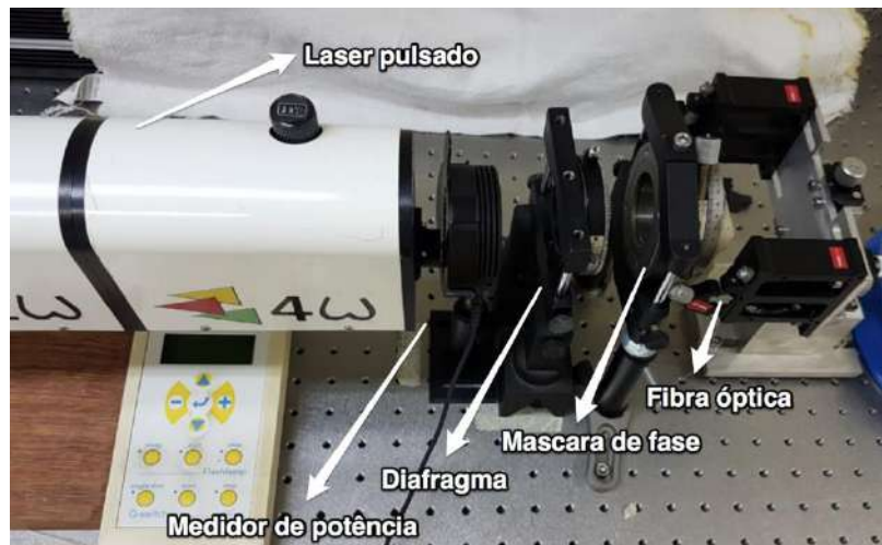
Figura 4.12.2 – Estrutura utilizada para fabricação de FBG via laser de pulso de argônio Nd: YAG
