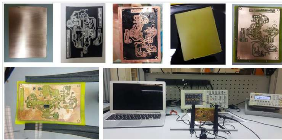
Figura 3.5.2 – Processo de fabricação da PCB.
