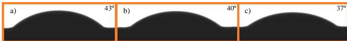
Figura 5.16: Interação do diiodometano com o papel vegetal tratado com metano, 50 W durante 10 minutos.
