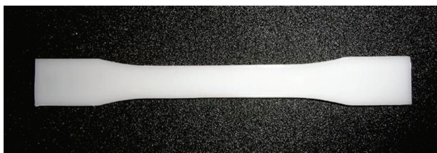
Figura 18 – Fotografia do corpo de prova processado, após etapas de moldagem, corte e acabamento.
