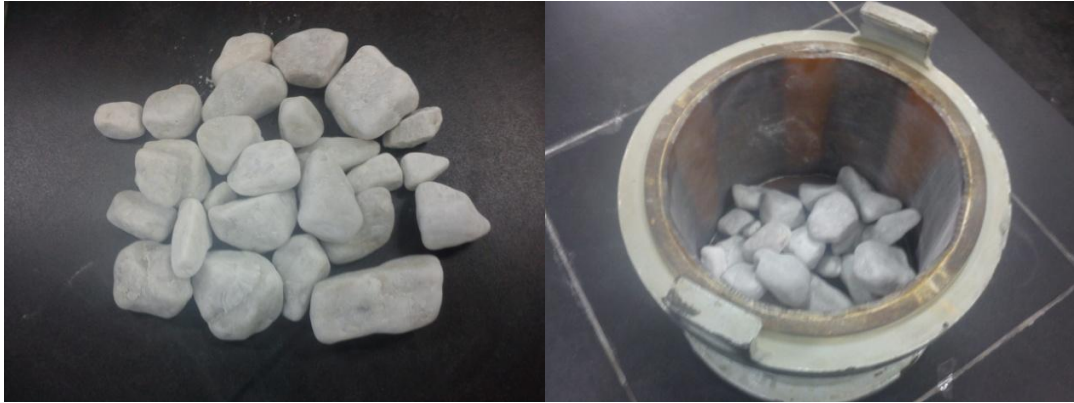
Figura 3.2 – Corpos moedores utilizados na moagem (a) Moinho (b)
