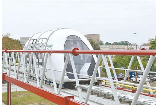
Figura 2.5: Trem maglev cobra desenvolvido no lasup.
