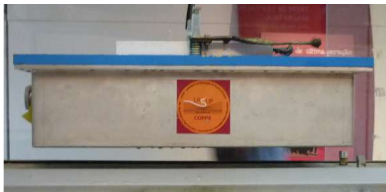
Figura 2.6: Demonstração da levitação supercondutora com criostato utilizado no veículo Maglev Cobra.
