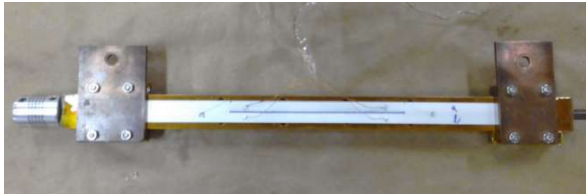
Figura 3.4: Porta amostra de cobre para estabilizar termicamente a fita durante os ensaios.
