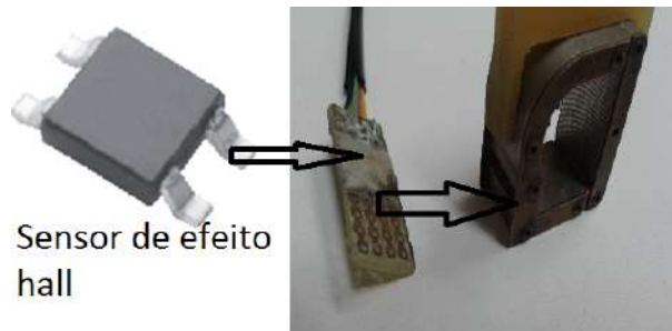
Figura 3.8: Sensor de campo de efeito hall soldado em pequena placa de circuito impresso, que é inserido no gap do núcleo de aço.
