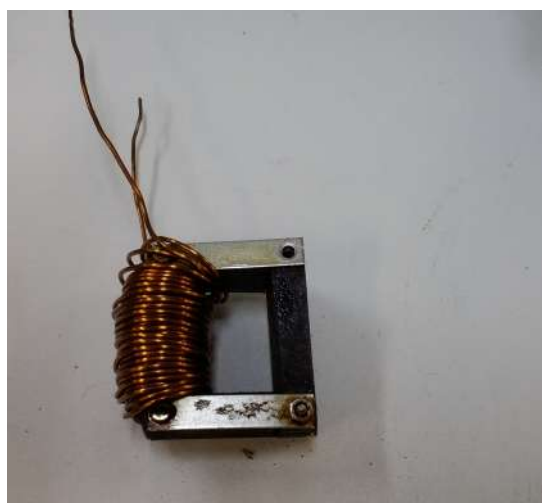
Figura 3.13: Núcleo ferromagnético com enrolamento primário de cobre utilizado para indução de campo magnético no interior do laço supercondutor.
