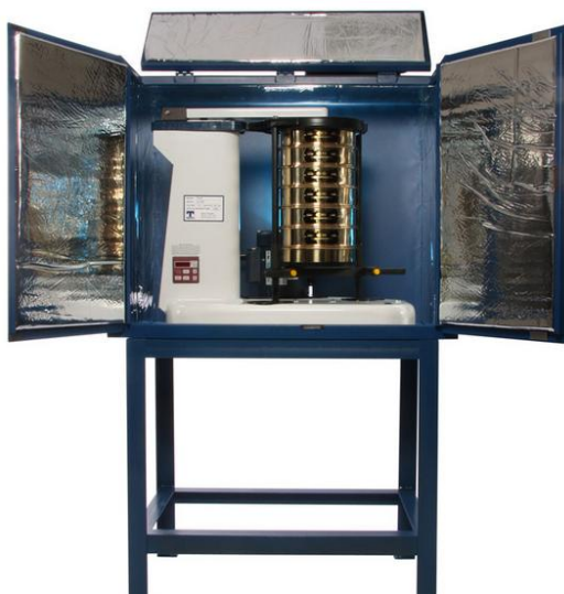
Figura 05 – Ro-Tap (peneiramento a seco). (Fonte: www.test-sieve.com )
