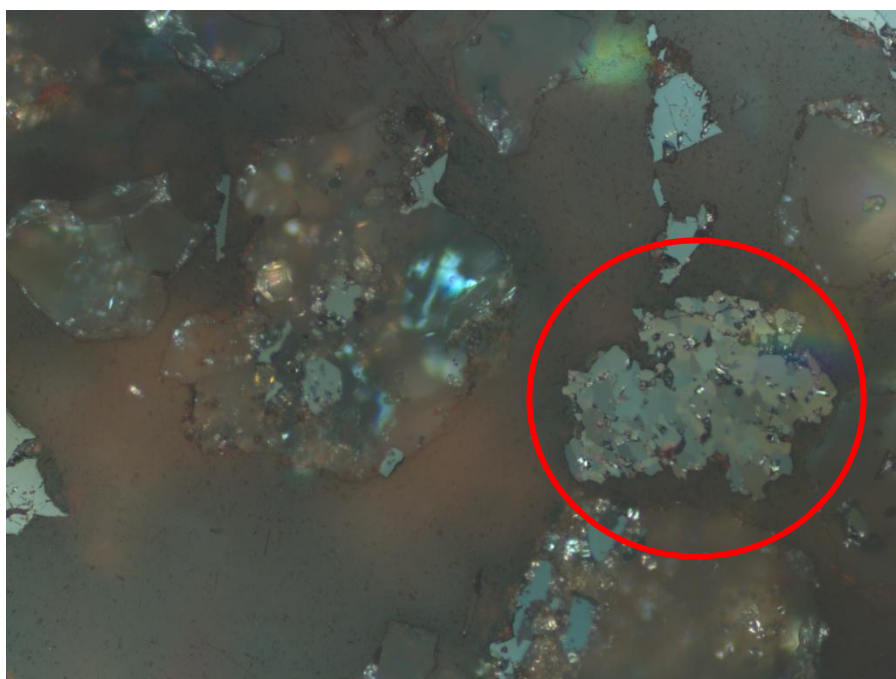
Figura 42 – Partícula de hematita lamelar de um campo da seção polida do produto concentrado da separação de alta intensidade (fração retida em 0,150 mm) observado com aumento de 20x em (a) BF (b) CPOL.
