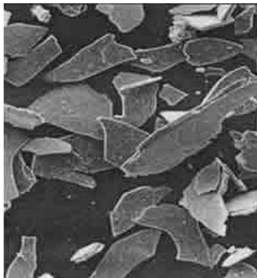
Figura 01 – Flocos de especularita observados ao microscópio ótico. Largura da Imagem: 0,150 mm (Fonte: http://myweb.tiscali.co.uk/tonyjewell/kellymine/paint.html , 2012)
