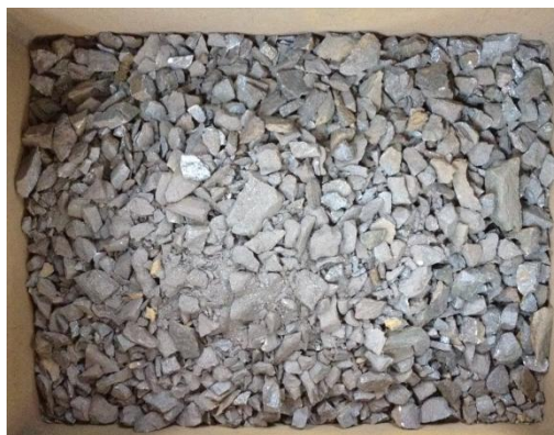
Figura 22 – Amostra de Minério de Ferro após a britagem primária.
