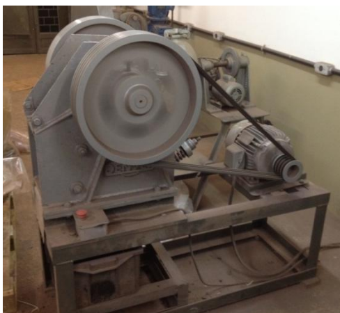
Figura 21 – Britador de Mandíbulas DENVER 5"x6" utilizado no Laboratório de Tecnologia Mineral (LTM)- UFRJ
