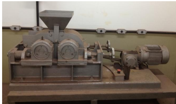
Figura 23 – Britador de Rolos DENVER 10"x11" utilizado no Laboratório de Tecnologia Mineral (LTM) - UFRJ
