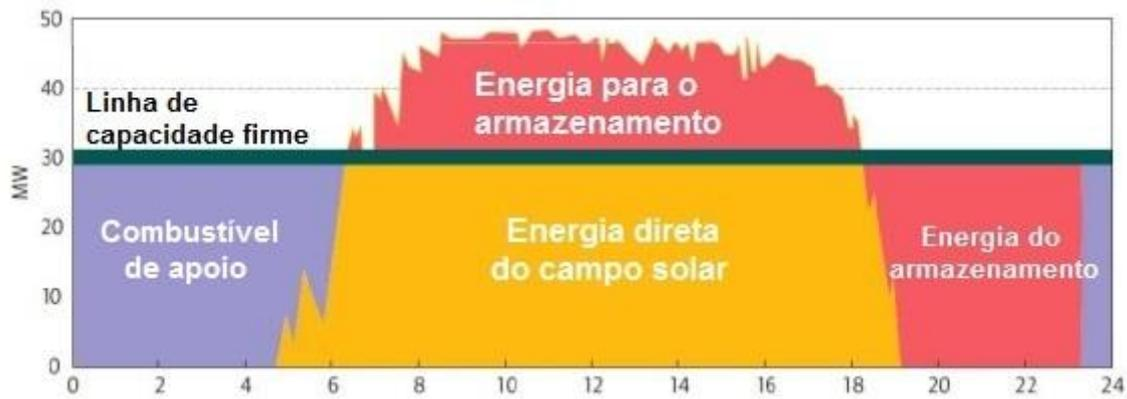
Figura 32 – Ciclo diário de usina ISCC com armazenamento térmico
