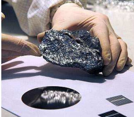
Figura 4.7 - Na mão do pesquisador uma amostra de silício metalúrgico, ainda impuro. Sobre a mesa, uma lâmina de silício purificado e as células solares fabricadas com ele [18]
