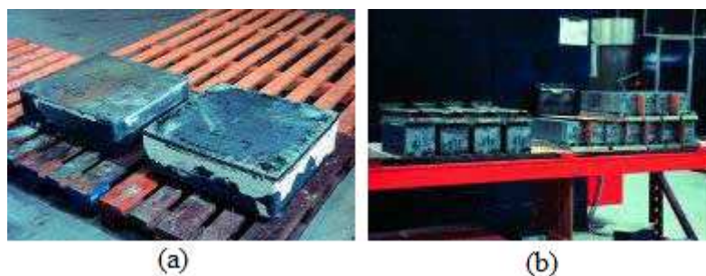
Figura 4.10 – (a) Blocos de silício policristalino fundidos; (b) Varetas de silício policristalino serrado
