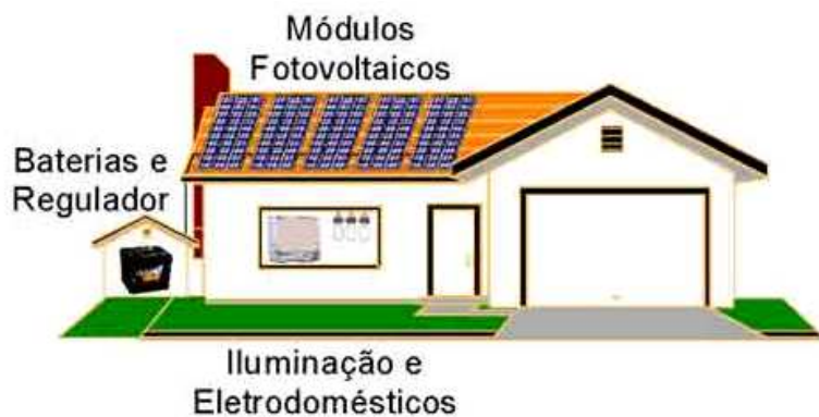
Figura 2.1 – Esquema de um sistema fotovoltaico autônomo
