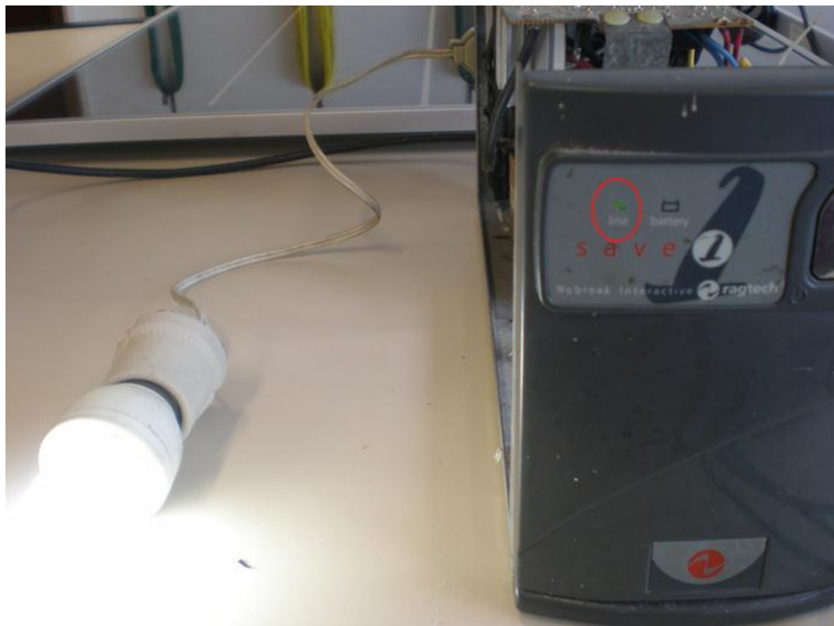
Figura 8.10 - No-break operando com fornecimento da rede
