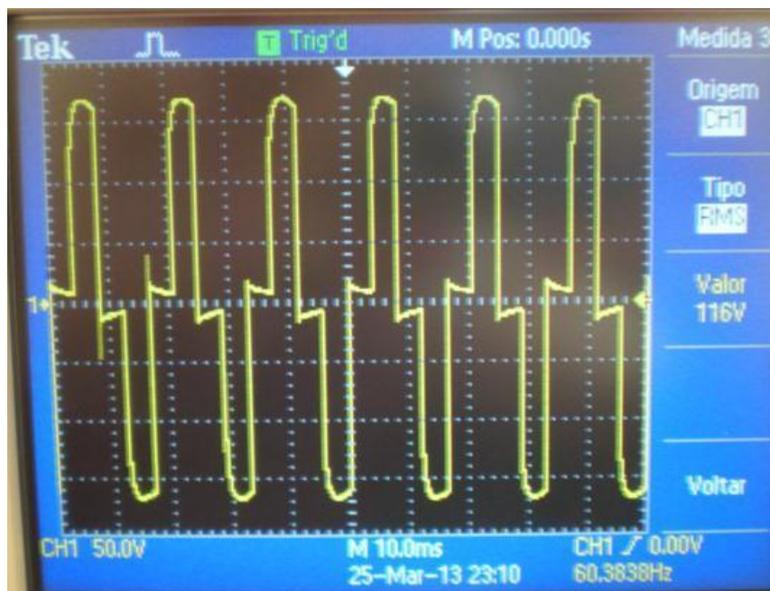
Figura 8.7 - Forma de onda na saída do no-break
