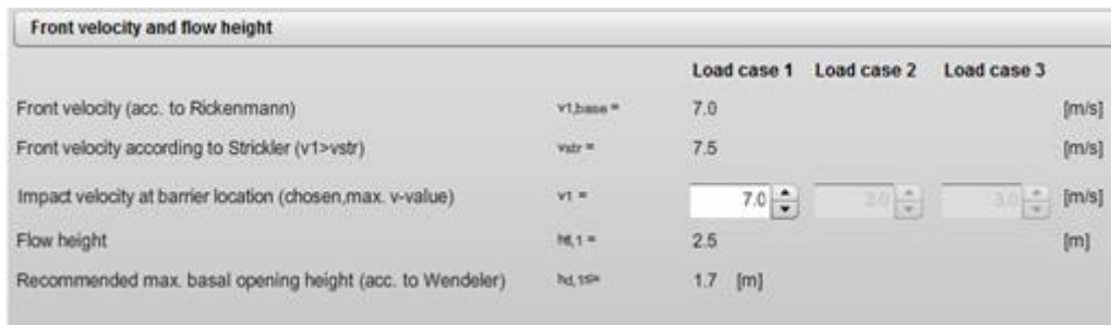
Figura 6. 20: Tela do DEBFLOW com altura e velocidade de impacto calculados para barreira 2
