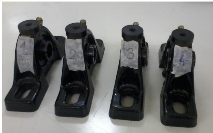
Figura 17 – Mancais defeituosos utilizados no experimento
