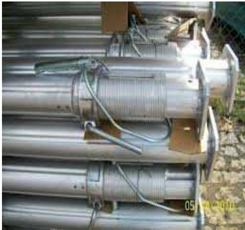
Figura : Escoras metálicas armazenadas.
