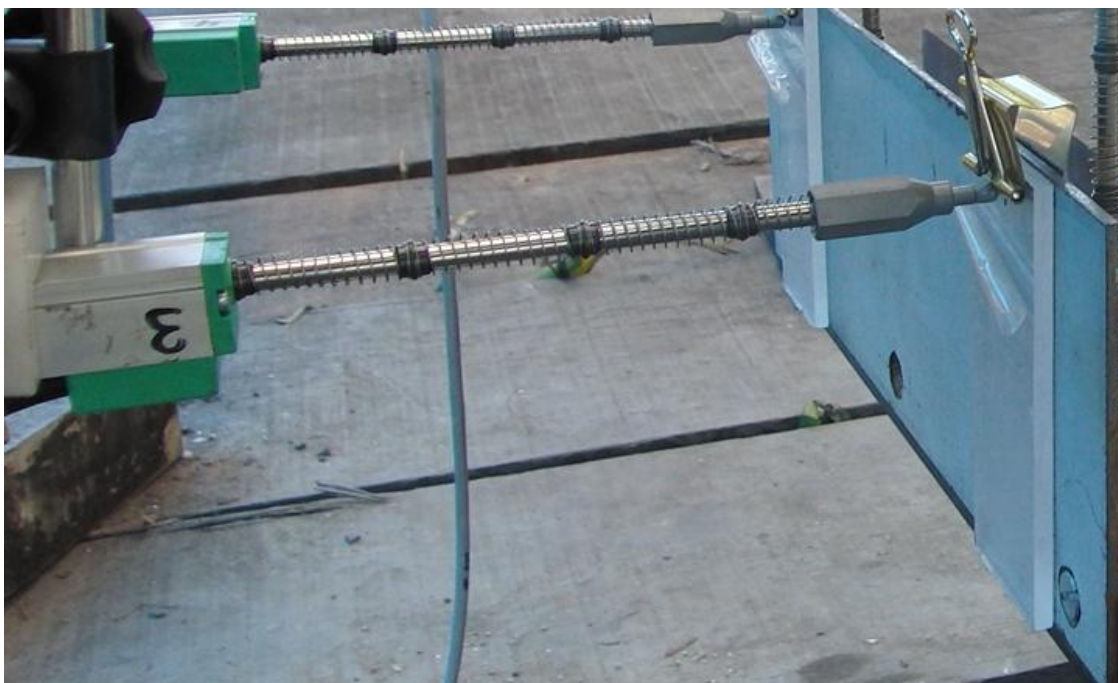
Figura 5.42 – Detalhe da ponta de um LVDT de medição do deslocamento horizontal, apoiado na base acrílica
