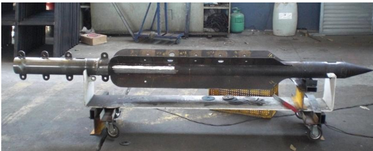
Figura 4.3 – Estaca-torpedo modelo após colocação do prolongador para aplicação dos carregamentos
