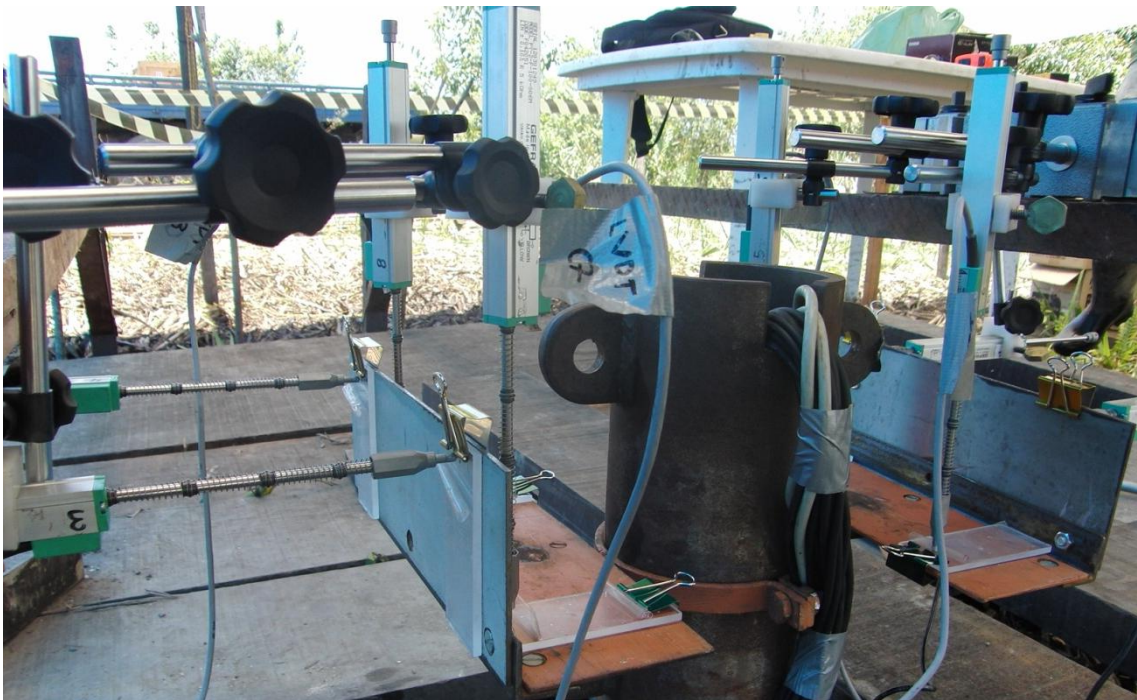
Figura 5.44 – Posicionamento dos LVDT's durante a prova de carga
