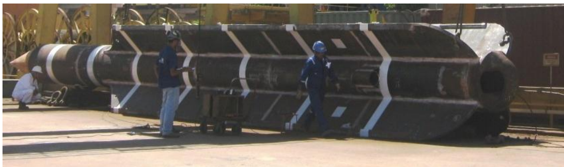
Figura 4.2 – Estaca-torpedo T-98 em tamanho real (imagem cedida pela PETROBRAS S.A. - proibida a reprodução sem prévia autorização da empresa)
