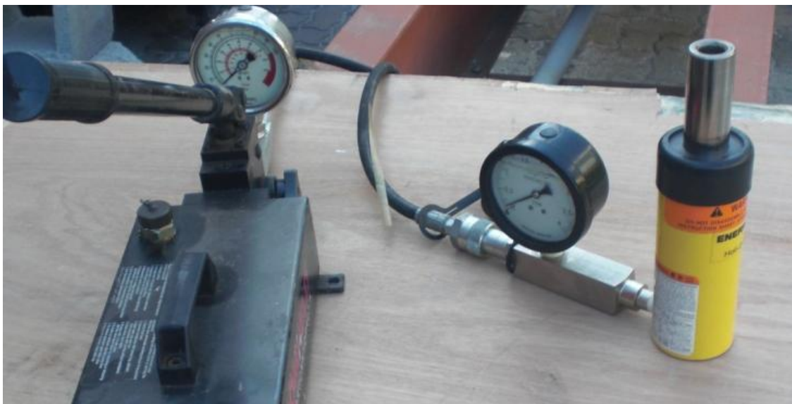
Figura 5.13 – Macaco hidráulico utilizado para aplicar carga de tração
