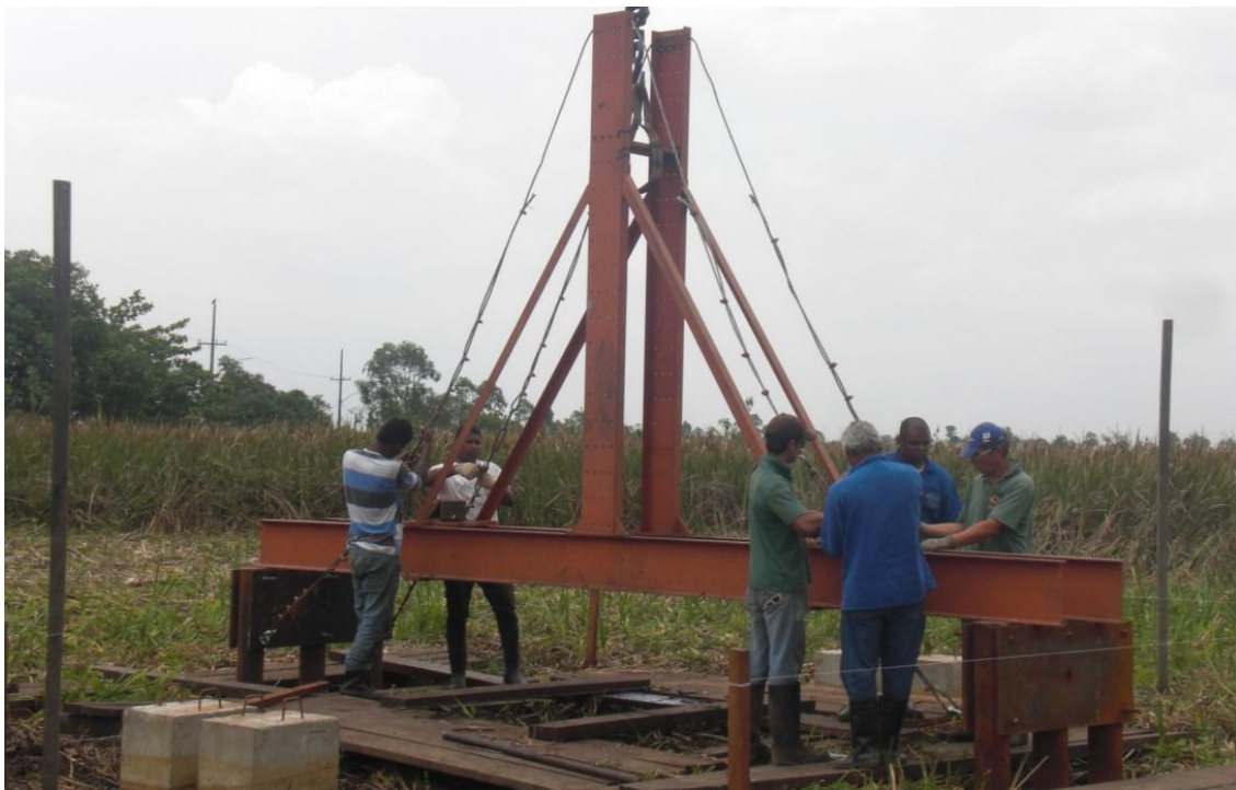
Figura 5.31 – Sistema de cravação posicionado para cravação da estaca-torpedo modelo
