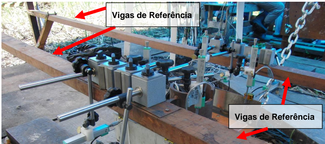
Figura 5.9 – Vigas de referência
