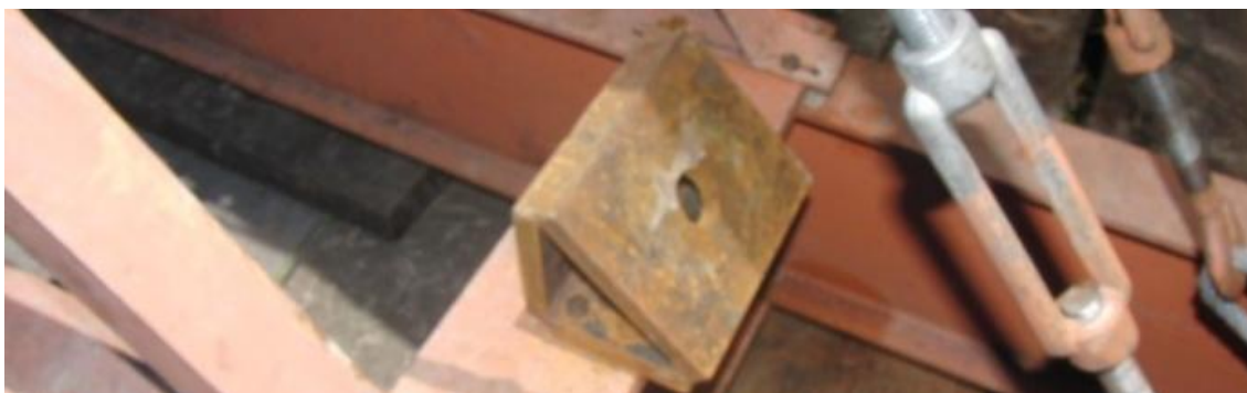
Figura 5.45 – Base de apoio do macaco utilizado na prova de carga
