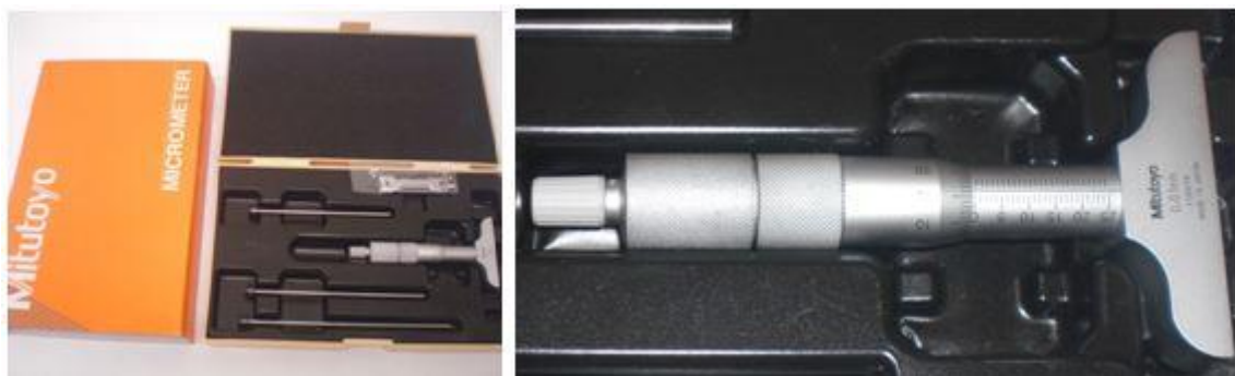
Figura 5.23 – Micrômetro utilizado para calibração dos LVDT's
