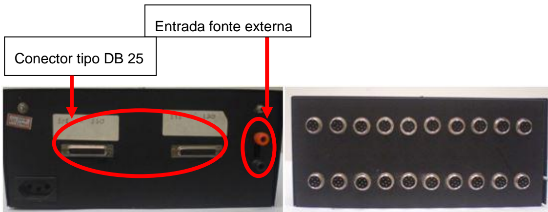
Figura 5.3 – Vista do fundo e da parte frontal das caixas de passagem
