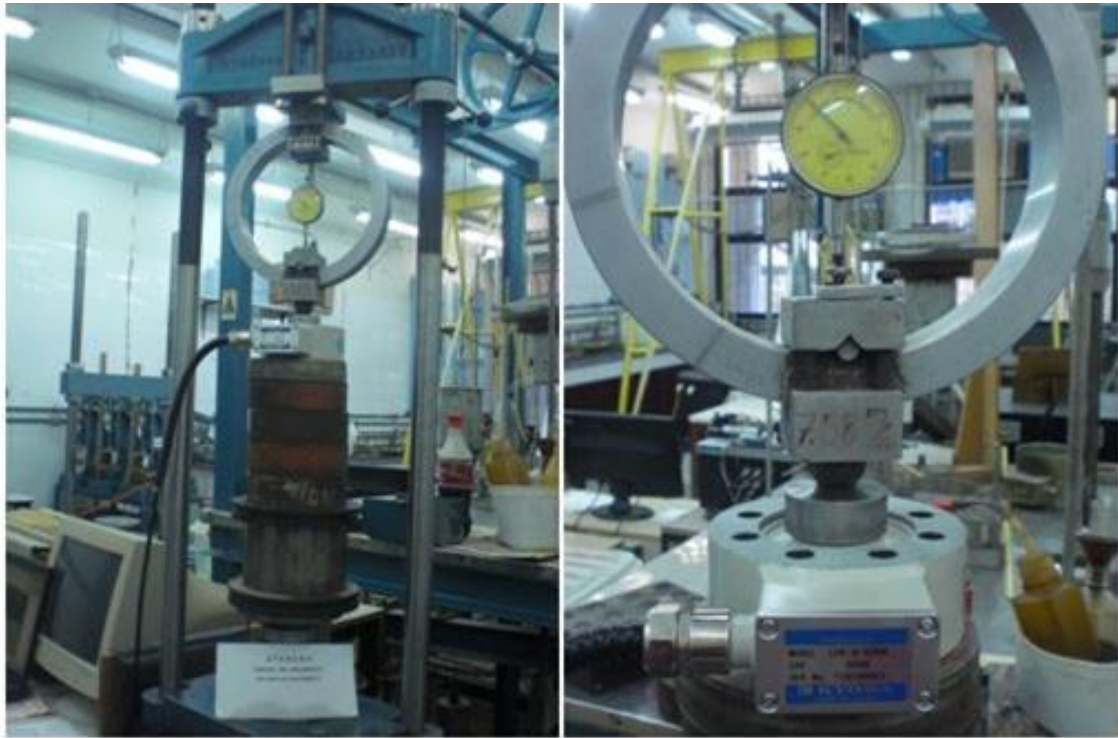
Figura 5.28 – Prensa utilizada na calibração da célula de carga
