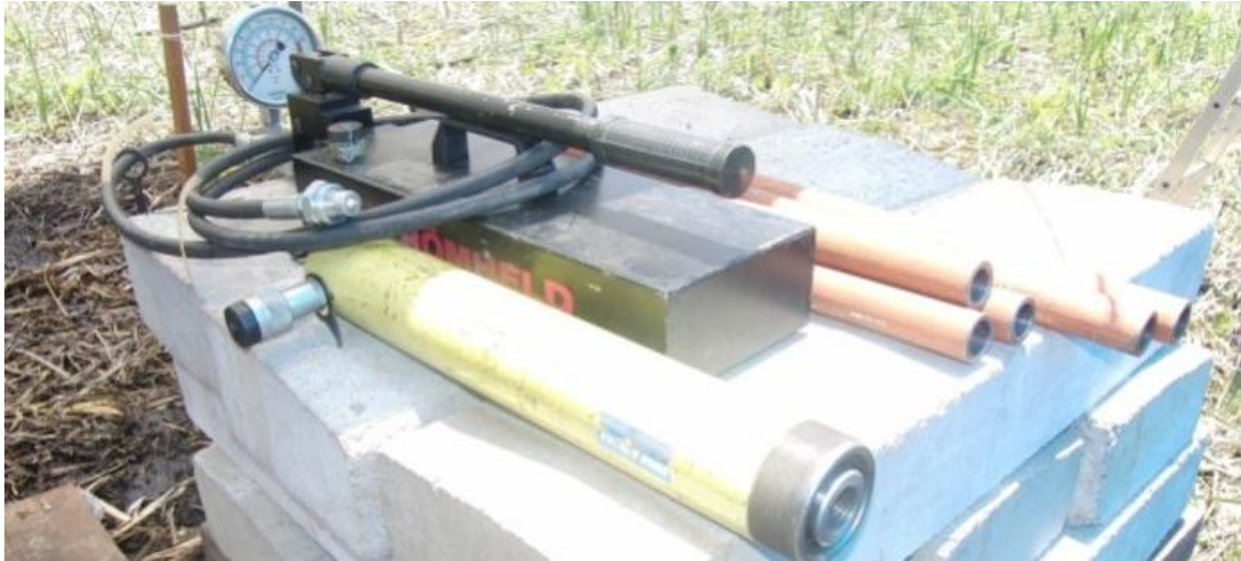
Figura 5.14 – Macaco hidráulico utilizado para cravação
