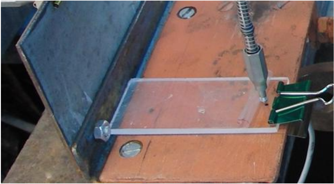
Figura 5.43 – Detalhe da ponta de um LVDT de medição do deslocamento vertical, apoiado na base acrílica
