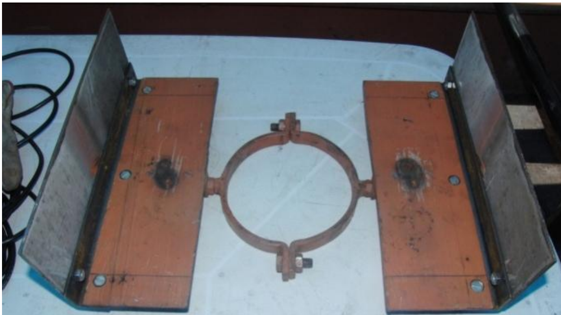
Figura 5.37 – Base para apoio dos medidores de deslocamento (LVDT's)
