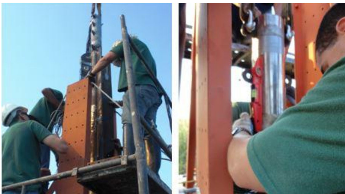
Figura 5.35 – Etapa inicial da cravação - peso próprio da estaca torpedo modelo
