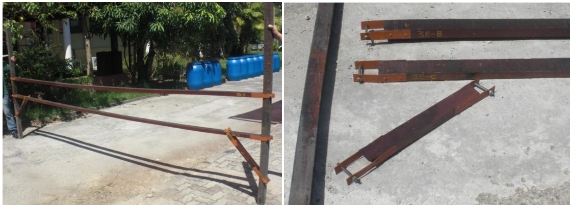
Figura 5.8 – Esquema de montagem prévia do sistema de referência de deslocamentos
