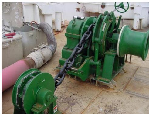
*Figura 2.20 – Ilustração de um Molinete.*
