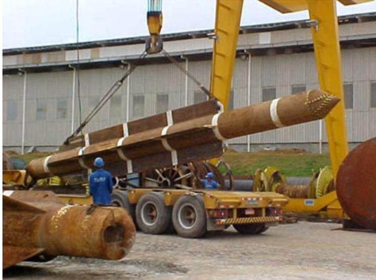
*Figura 2.19 – Ilustração de uma Estaca Torpedo.*
