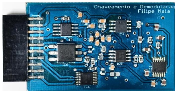
**Figura 18: Placa que compõe a etapa de chaveamento e de demodulação de cada eletrodo do TBE.**
