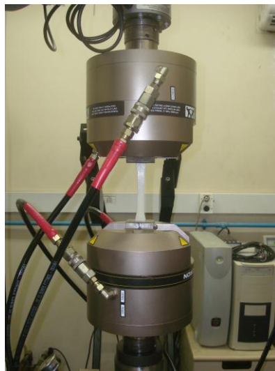
Figura 56: Teste de Tração Uniaxial a uma Taxa de Deformação de 5mm/min.
