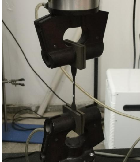
Figura 69: Teste de Tração Uniaxial à Taxa de Deformação de 50 mm/min
