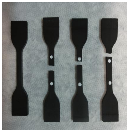
Figura 70: Comparação entre as Geometrias dos Corpos de Prova antes e após o Teste de Tração Uniaxial.
