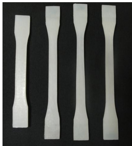
Figura 57: Comparação entre as Geometrias dos Corpos de Prova antes e após o Teste de Tração Uniaxial a uma Taxa de Deformação de 5mm/min.
