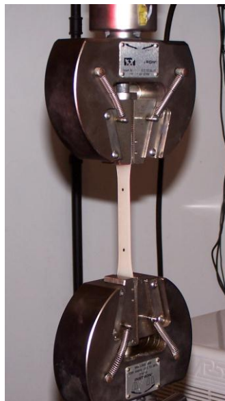
Figura 61: Teste de Tração Uniaxial a uma Taxa de Deformação de 50 mm/min.
