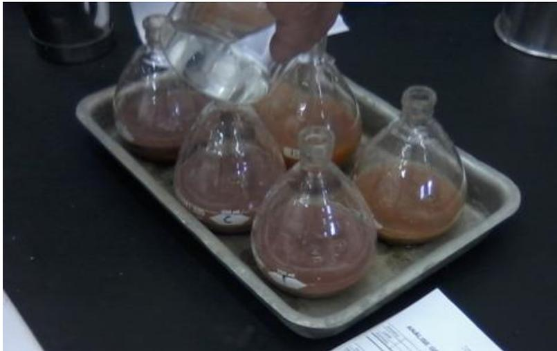
Figura 3.7 – Picnômetro com amostras cobertas por água destilada para ensaio de massa específica
