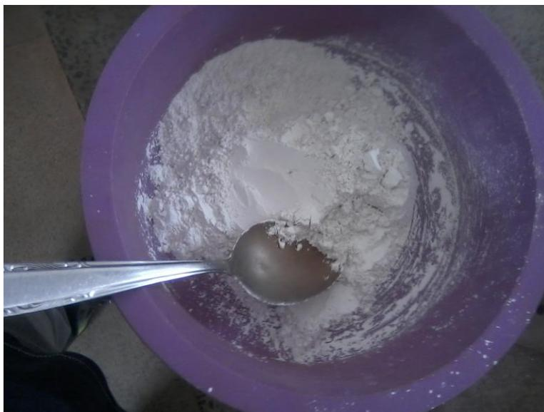
Figura 3.3 – Amostra de Cal Calcítica utilizada neste trabalho
