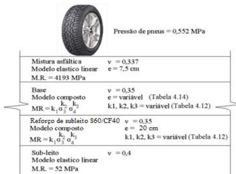
Figura 4.9 – Estrutura do Pavimento Típico adotada para análise mecânica-empírica com camada de S60/CF40 como reforço de subleito
