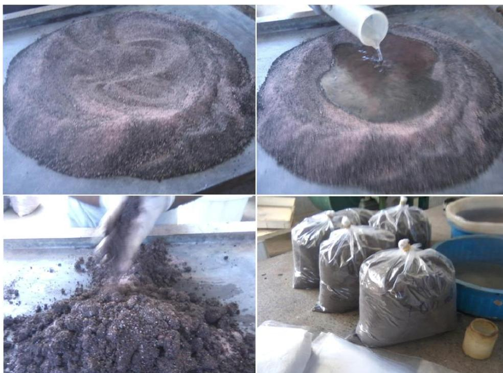
Figura 3.4 – Sequencia de preparação da mistura dos materiais neste trabalho
