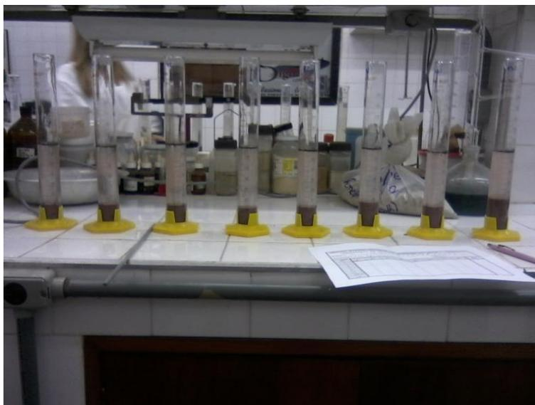
Figura 3.9 – Provetas contendo a mistura ensaiada com água destilada no ensaio físico-químico de dosagem
