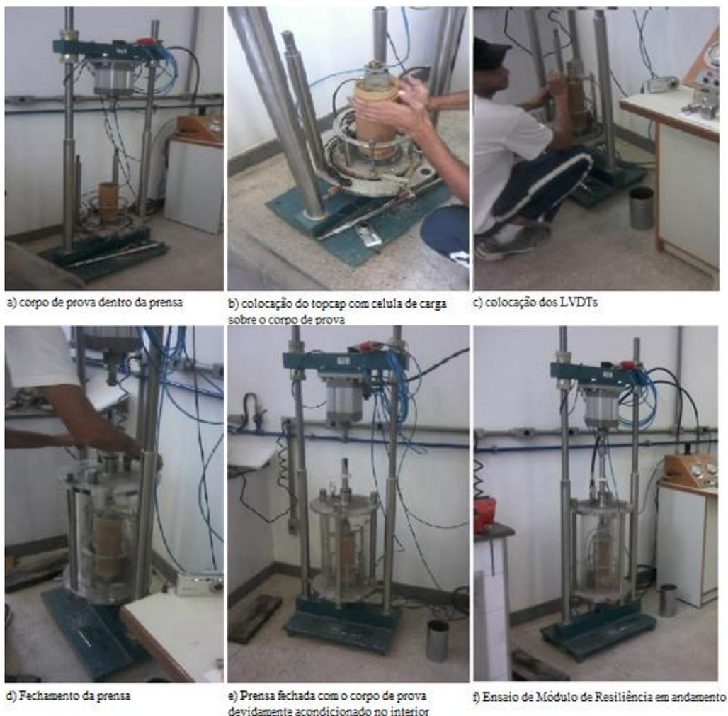
Figura 3.14 – Sequencia de montagem do equipamento triaxial de carga repetida
