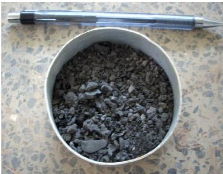
Figura 3.2 – Amostra de Cinza de Fundo de RSU da USINAVERDE (VIZCARRA, 2010)
