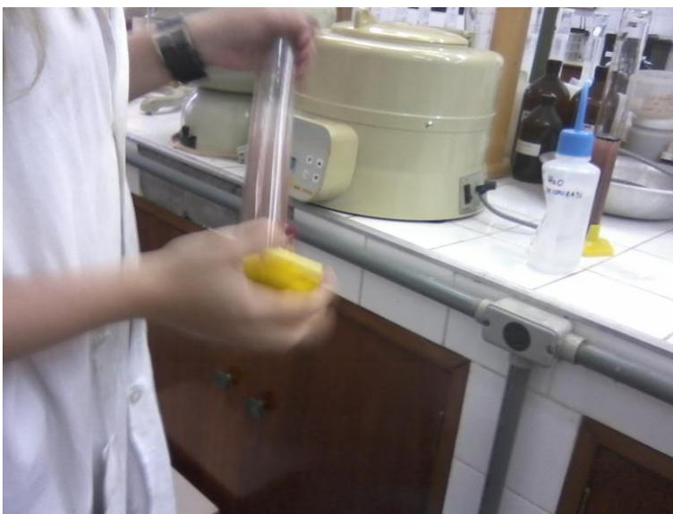
Figura 3.10 – Proveta sendo agitada para homogeneização no ensaio físico-químico de dosagem
