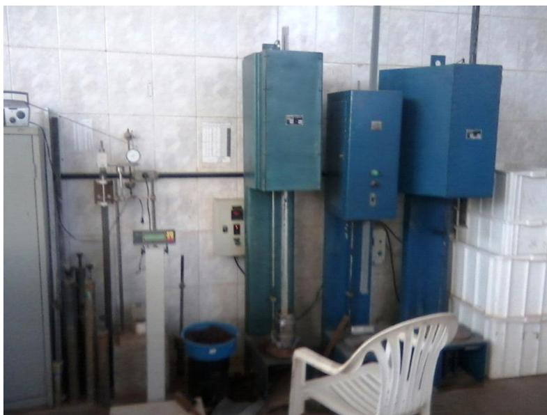
Figura 3.11 – Compactador mecânico utilizado para moldar os corpos de prova
