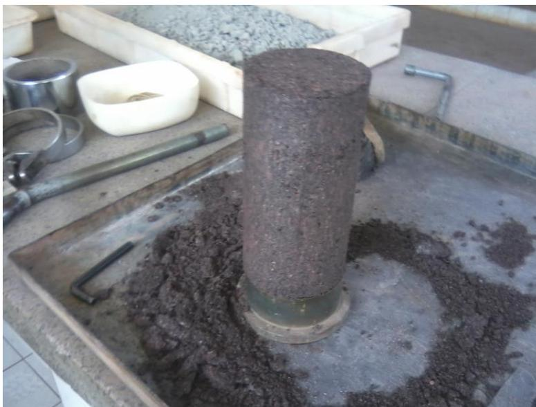
Figura 3.12 – Corpo-de-prova moldado em molde tripartido no compactador mecânico
