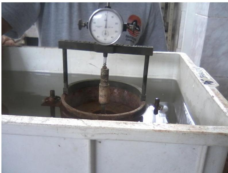
Figura 3.13 – Cilindro imerso com extensômetro instalada para realizar leituras de expansão- ensaio CBR
