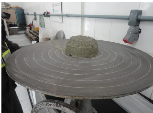
Figura 8 - Ensaio para a determinação do índice de consistência – Realizado no laboratório HOLCIM S/A.
