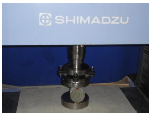
Figura 11 - Prensa utilizada nos ensaios de resistência à tração por compressão diametral – Realizado no laboratório de estruturas LABEST - LEM, UFRJ.
