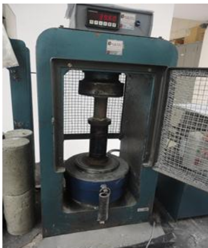
Figura 10 - Prensa utilizada nos ensaios de resistência à compressão – Realizado no laboratório HOLCIM S/A.
