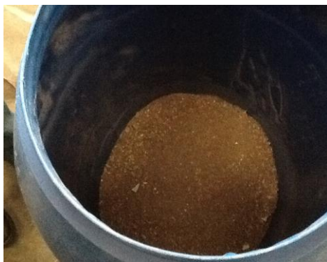
Figura 6 - Resíduo cerâmico após britagem na queixada.
