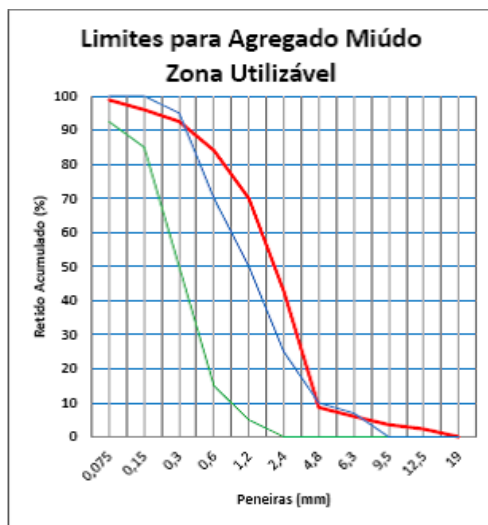
Figura 7 - Limites inferior e superior para a zona utilizável conforme estabelecido pela NBR 7211 (ABNT, 2005). Fonte: Desenvolvido pela autora.
