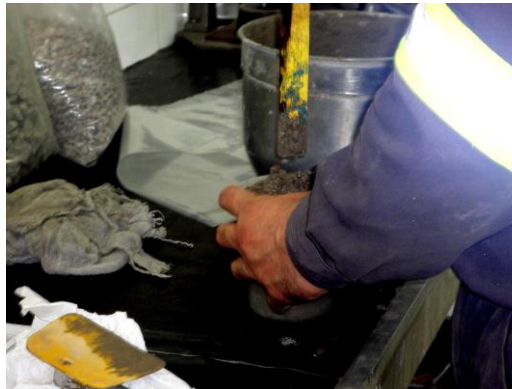
Figura 9 - Ensaio para a determinação da densidade de massa e teor de ar incorporado – Realizado no laboratório HOLCIM S/A.
