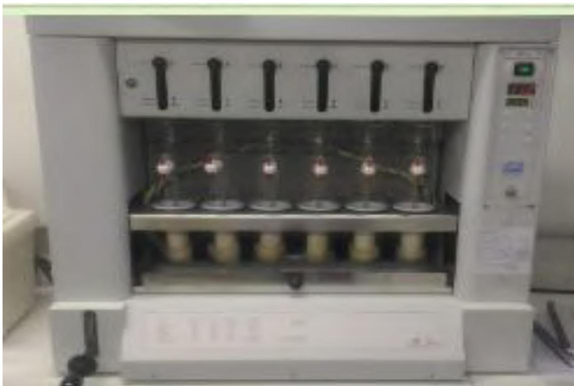
**Figura 49- Equipamento de extração de lipídios**
