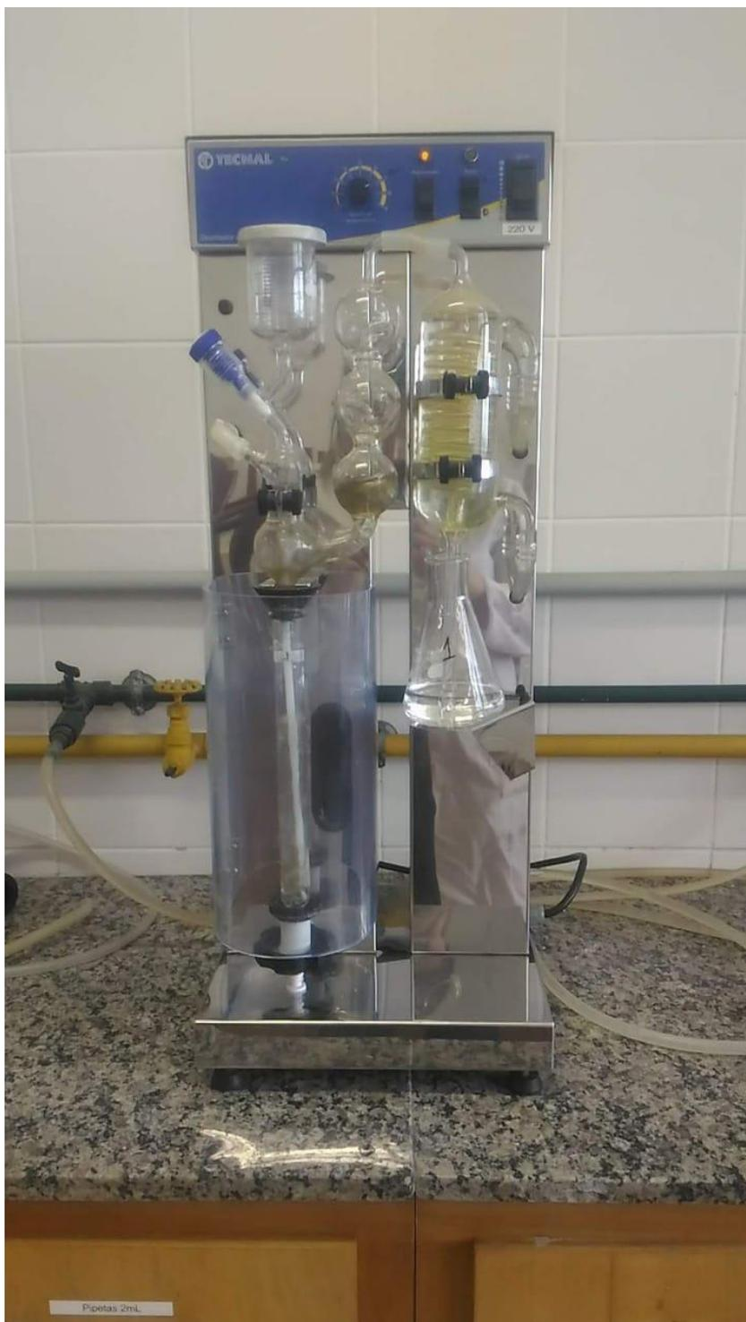
Figura 53- Equipamento de destilação utilizado na técnica de proteínas
