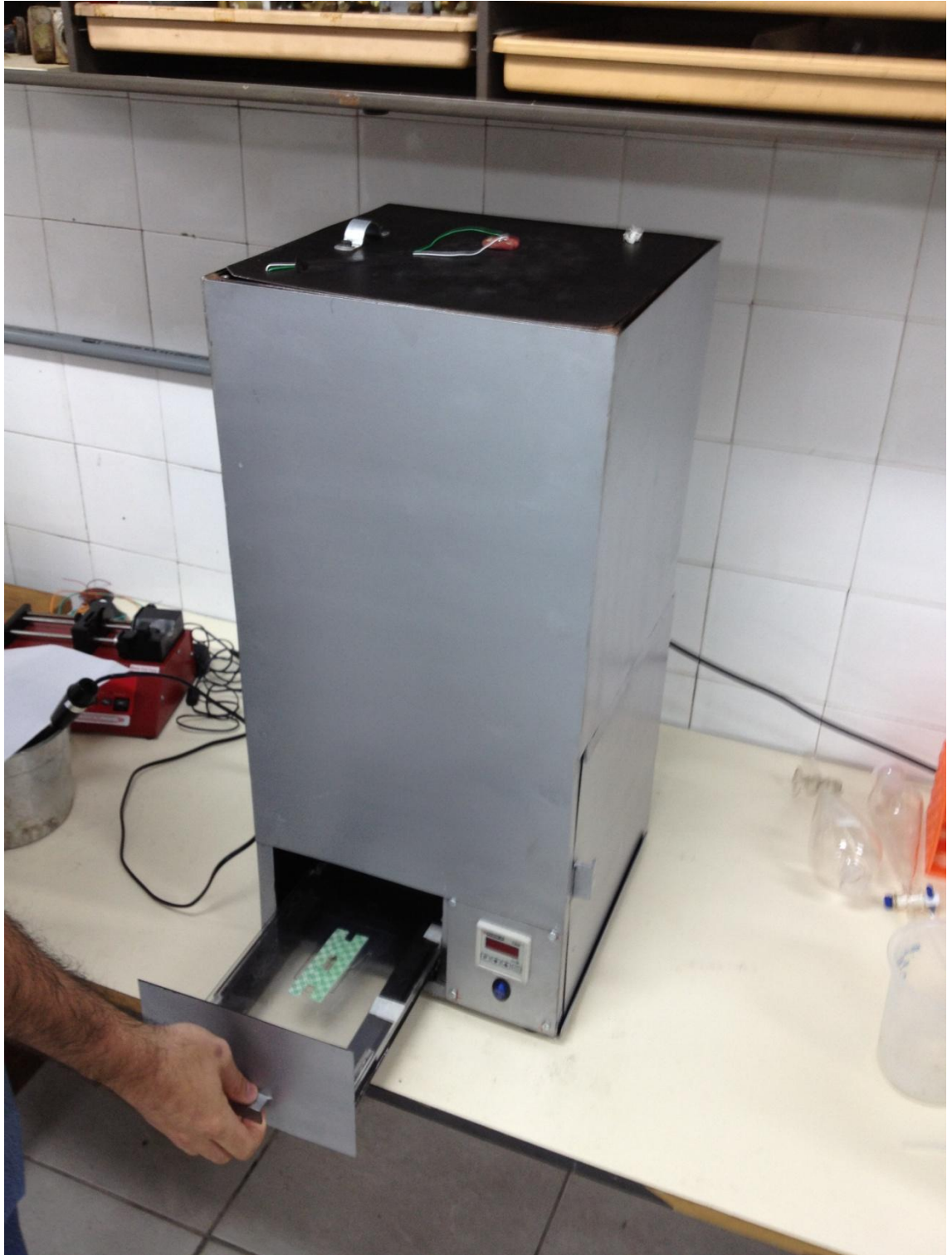
Figura 5.11 - Fotoexpositora de luz pontual com conjunto máscara + substrato sendo inserido para posterior exposição a UV
