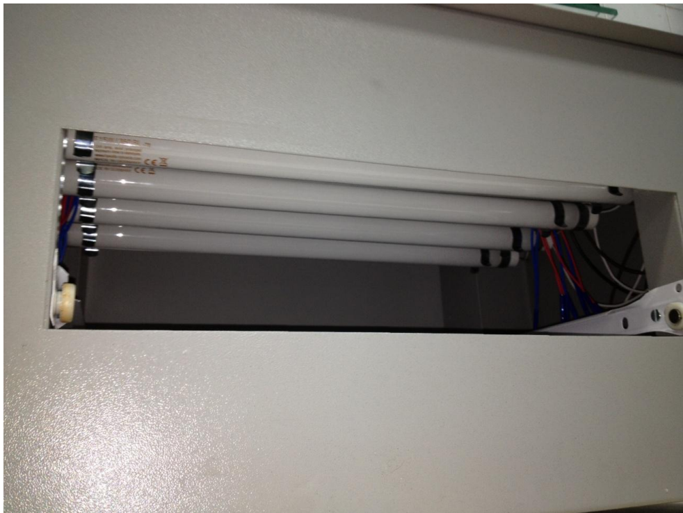
Figura 4.3 - lâmpadas superiores da fotoexpositora (conjunto de 4 lâmpadas tubulares)
