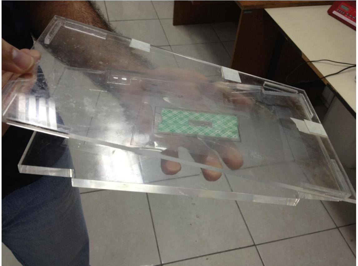
Figura 5.15 - Suporte de acrílico utilizada para conter o conjunto máscara + substrato durante a exposição
