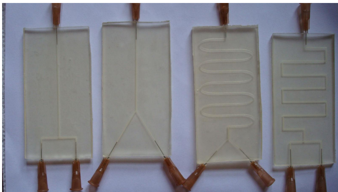
Figura 3.10 -- Microsistemas fluídicos fabricados por fotolitografia usando a uretana-acrilato e a fotoexpositora comercial
