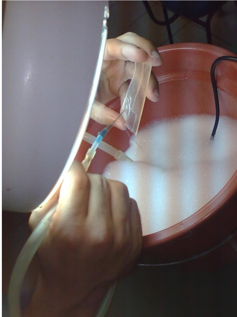
Figura 3.7 - remoção do polímero não polimerizado restante com o uso de um jato de água e detergente direcionados
