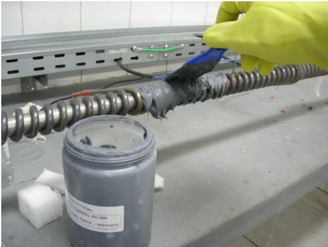
Figura 2.13 - – Aplicação de pasta térmica no contato entre o tubo e as resistências elétricas.
