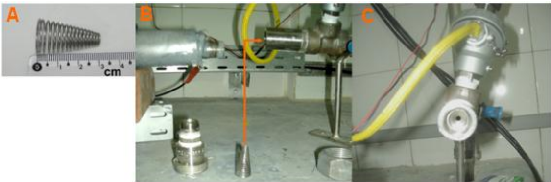
Figura 2.9 - A- misturador em detalhe ; B- instalação do misturador; C- mola já instalada.
