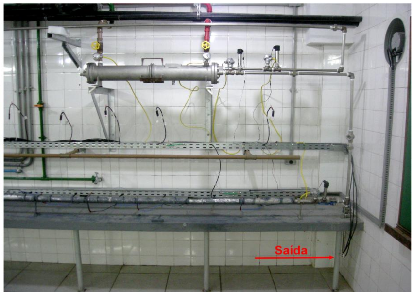
Figura 2.19 - Dreno inferior da seção de testes.
