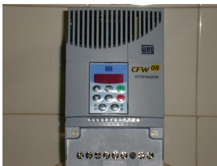
Figura 2.5 - Inversor de frequência WEG CFW08
