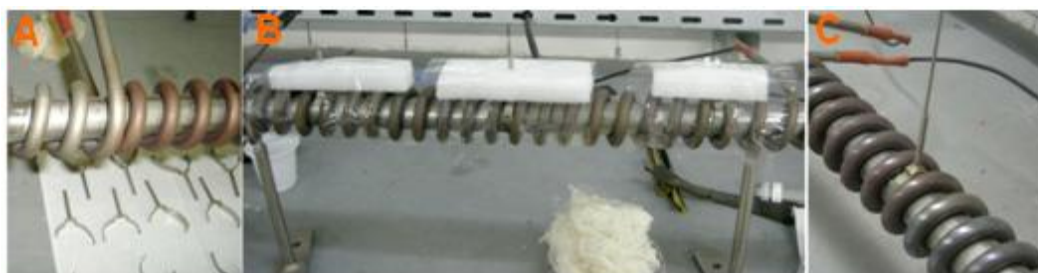
Figura 2.12 - A- Suportes a serem colados; B-Cola curando e C –Termopar encaixado no suporte.
