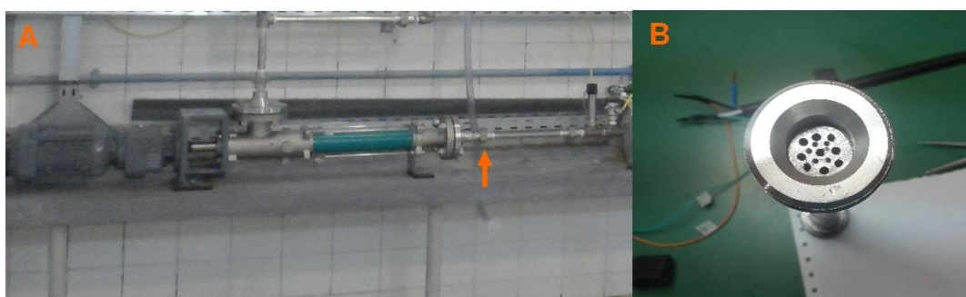
Figura 2.4 - A- local onde foi instalada a placa de orifícios; B- placa de orifícios dentro
