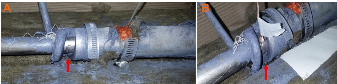
Figura 2.17 - A-Preparação da superfície com o rasgo; B- Termopar colado, cola curando.
