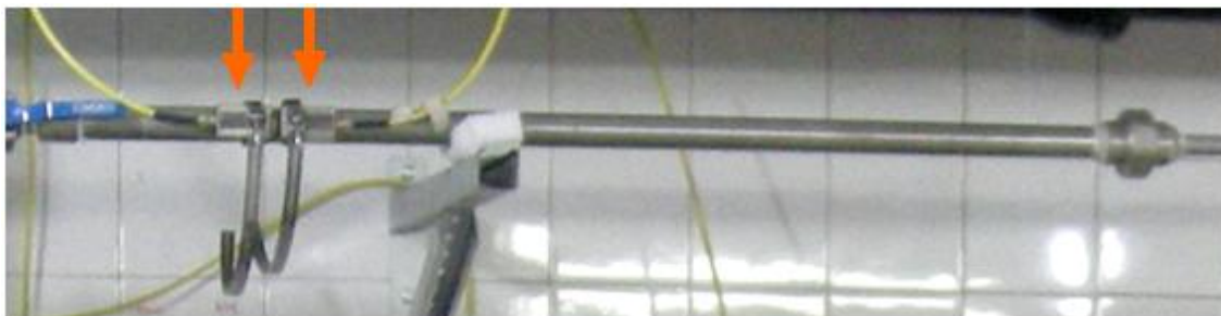
Figura 2.23 - Transdutores do medidor de vazão ultrassônico
