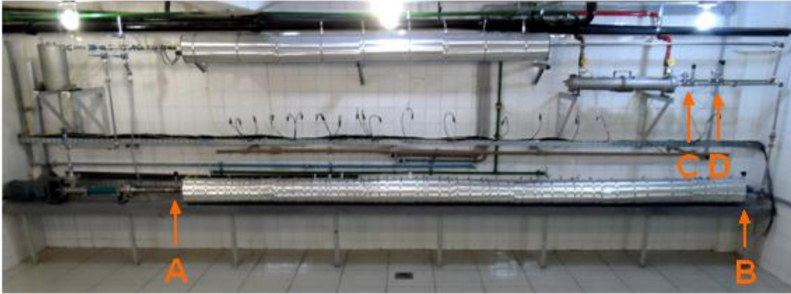
Figura 2.8 - Localização dos conjuntos termopar-transdutor ao longo do circuito primário. A. Entrada da seção de testes; B. Saída da seção de testes; C. Entrada do trocador de calor; D. Saída do trocador de calor
