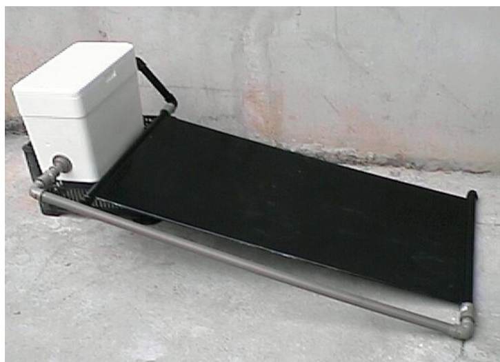
Figura 4.3 - Sistema de aquecimento solar com coletor de PVC
