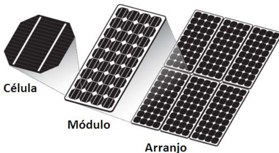
Figura 2.7 - Célula fotovoltaica, módulo e arranjo de painéis
