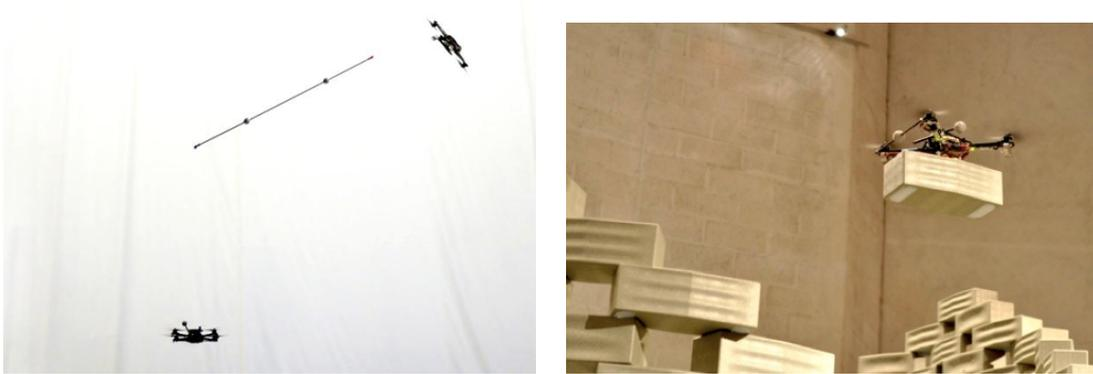
(a) Quadricópteros executando malabarismo com haste. Figura obtida de [Tech, n.d.]. (b) Quadricóptero empilhando blocos. Figura traída de [Eddy, 2011b].
