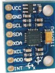
Figura 2.3: Placa de circuito com MPU6050 (IMU), MS5611-01BA01 (barômetro) e HMC5883L (magnetômetro). A orientação dos eixos  $x$  e  $y$  considerada pela IMU encontram-se indicadas na placa.
