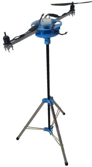
Figura 2.18: Estrutura de teste 4DOF com quadricóptero parcial (apenas duas hastes e um motor com hélice).
