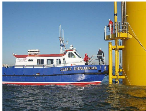
Figura 2.2: Exemplo de transferência realizada através de um Barco Tripulação (Imagem retirada de ngboat.com)
