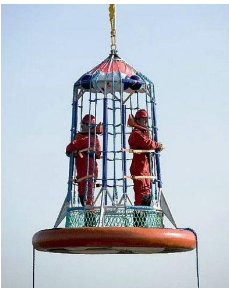
Figura 2.4: Personnel Basket Esvagt, deslocando duas pessoas. (Imagem retirada de esvagt.dk.)
