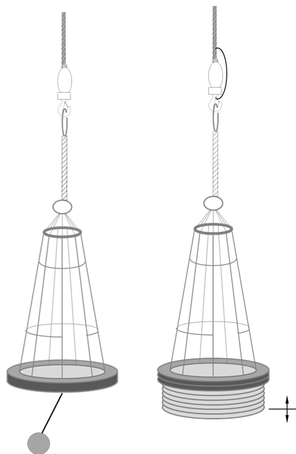
Figura 4.14: Mecanismo de encapsulamento do peso morto.
