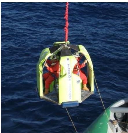
Figura 2.5: Exemplo de uma Personnel Transfer Capsule em utilização. (Imagem retirada de offshore-news.eu)
