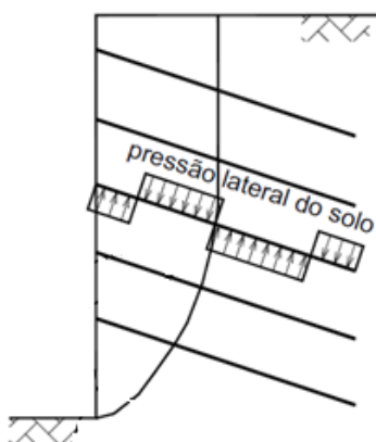
Figura 2. 8 - Distribuição dos empuxos passivos ao longo dos grampos (adaptado de SILVA, 2010).
