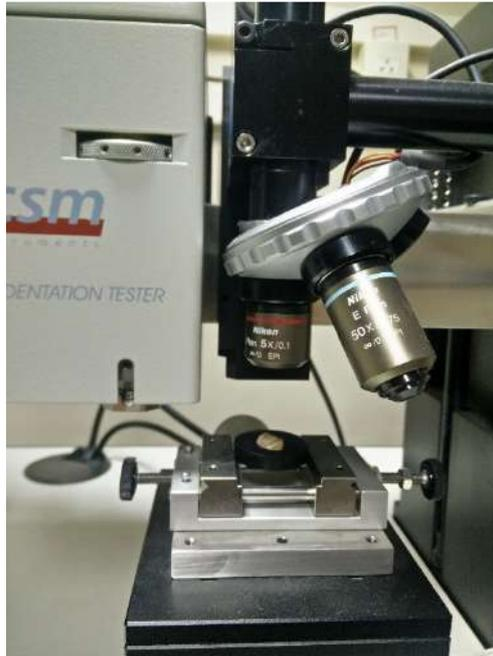
Figura 3.25: Amostra preparada para indentação.
