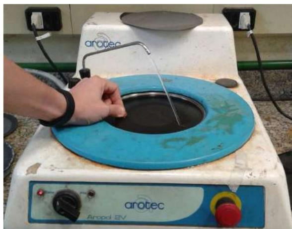
Figura 3.24: Lixamento da amostra de agregado para indentação.
