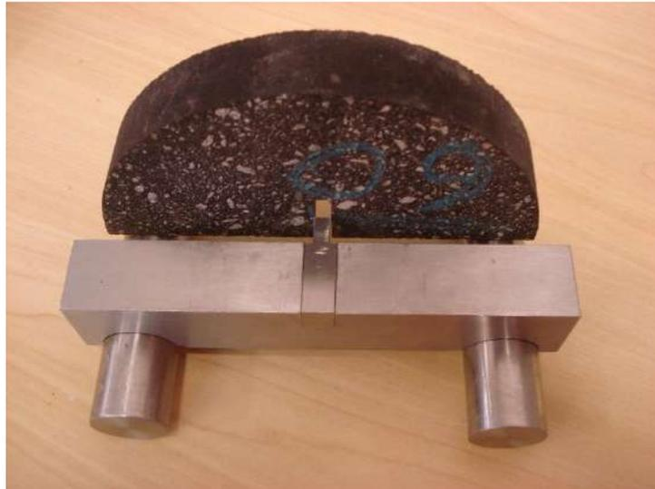
Figura 3.35: Exemplo do guia metálico sendo utilizado para a centralização de uma amostra.
