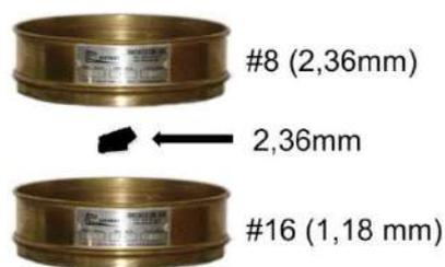
Figura 3.17: Exemplo de redimensionamento forçado de agregados.
