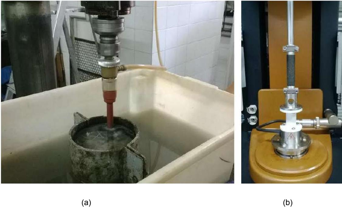
Figura 3.26: (a) extração de amostras MAF (b) amostras sendo ensaiadas no DSR.
