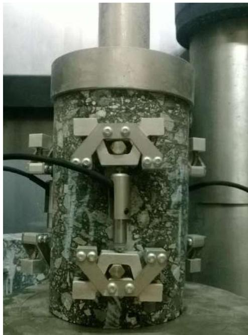
Figura 3.29: Instalação dos LVDTs na amostra de módulo dinâmico (PAZOS, 2015).
