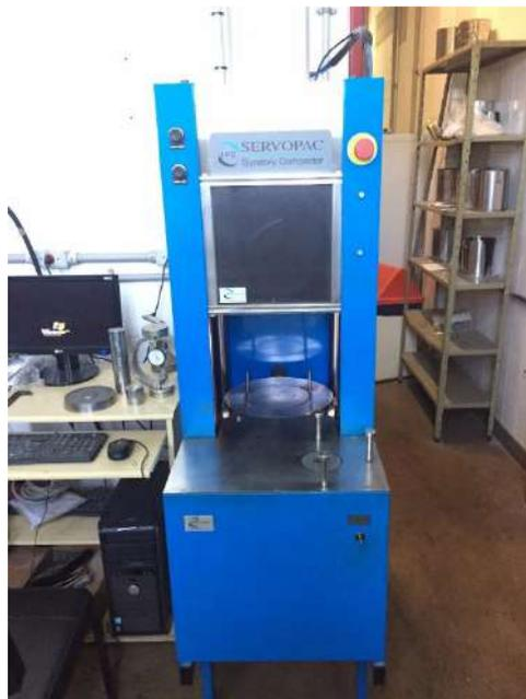
Figura 3.22: Compactador giratório Superpave da COPPE utilizado nesta tese.
