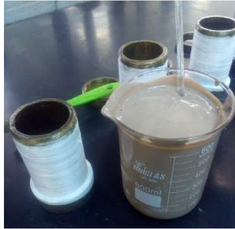
Figura 3.21: Molde vedado com fita teflon prévio à realização da moldagem.
