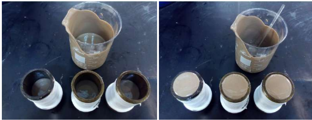
Figura 3.21: Molde vedado com fita teflon prévio à realização da moldagem.
