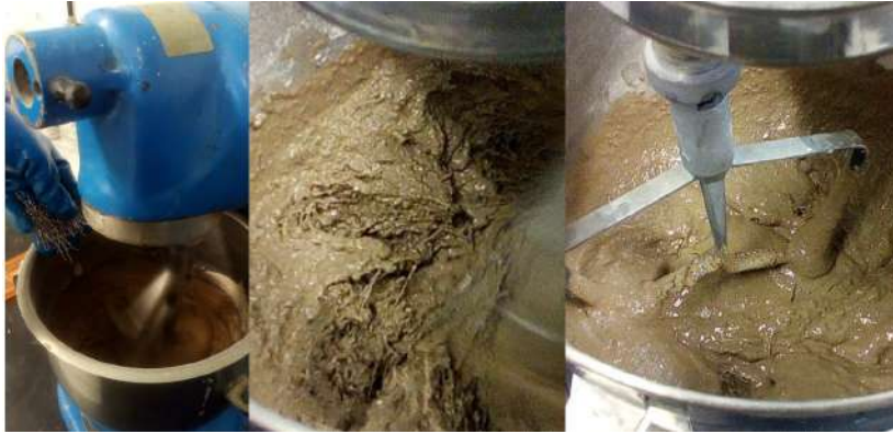
Figura 3.17: Adição das fibras de aço nas argamassas e aparência física dos compósitos geopoliméricos.
