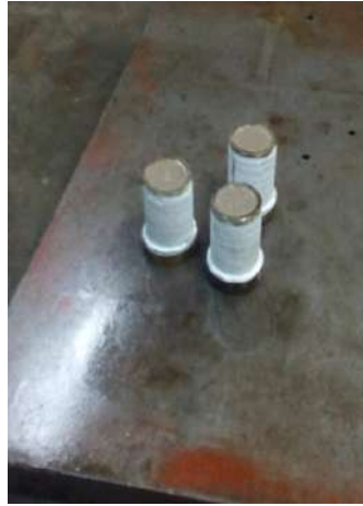
Figura 3.23: Moldes enchidos colocados sobre a mesa vibratória.
