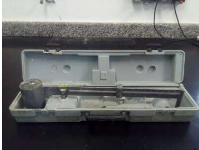
Figura 3.19: Balança de lama utilizada na determinação da massa específica aparente das pastas em estado fresco.
