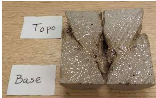
Figura 4.4: Corpo de prova seccionado longitudinalmente.
