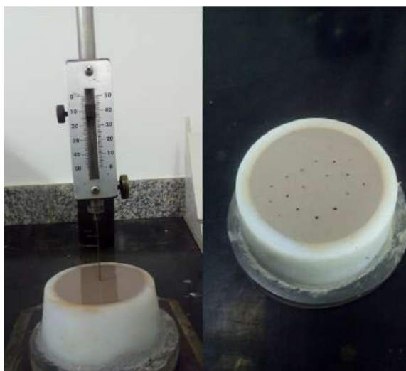
Figura 3.20: Determinação dos tempos de pega inicial e final, mediante ensaio da Agulha de Vicat.
