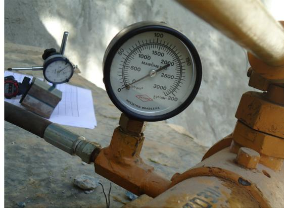
Figura 62: Detalhe do manômetro usado no ensaio
