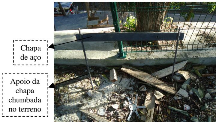
**Figura 58:** chapa de aço usada de referência indeslocável
