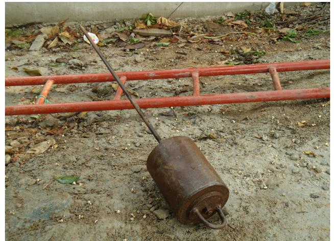
**Figura 14:** detalhe do martelo padronizado
