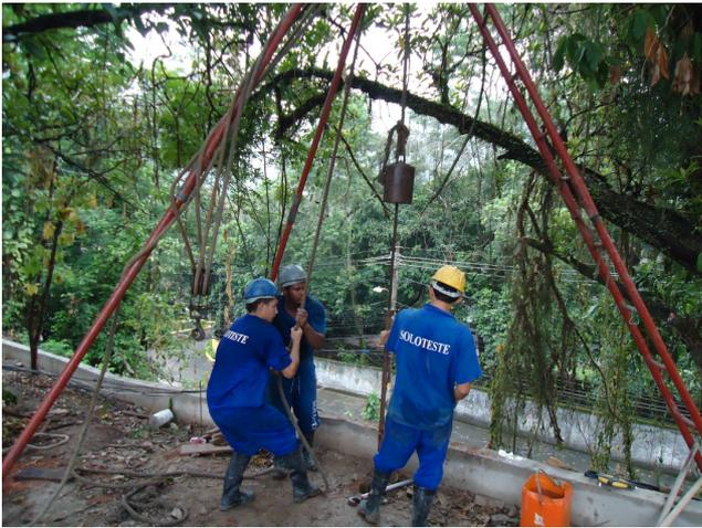
**Figura 49:** Ensaio de SPT sendo realizado
