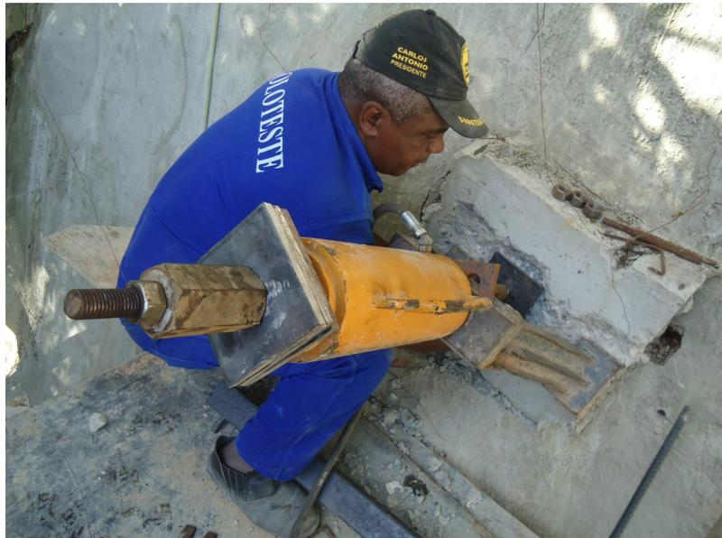
**Figura 66:** Montagem do Ensaio – base, macaco e prolongador instalado
