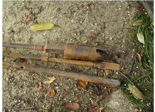
**Figura 12:** De cima para baixo: o trado, a faca de lavagem e o amostrador-padrão
