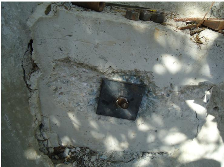
**Figura 60:** Detalhe da preparação da superfície de concreto para a realização do ensaio de arrancamento
