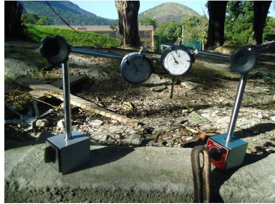
**Figura 59:** Detalhe dos extensômetros usados para as leituras de deslocamento do ensaio
