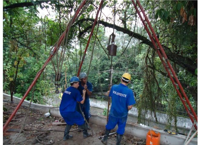
**Figura 20:** Ensaio de SPT – cravação do amostrador-padrão a partir de golpes com o martelo
