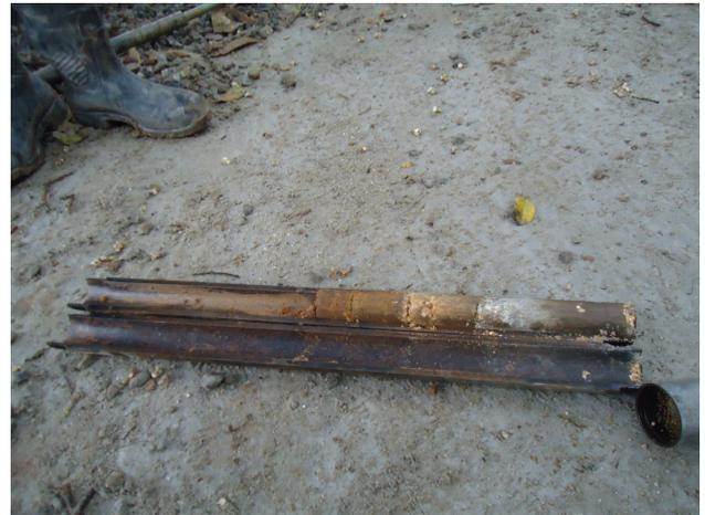
**Figura 21 e 22:** amostrador aberto – em detalhe, a amostra coletada em um ensaio de cravação
