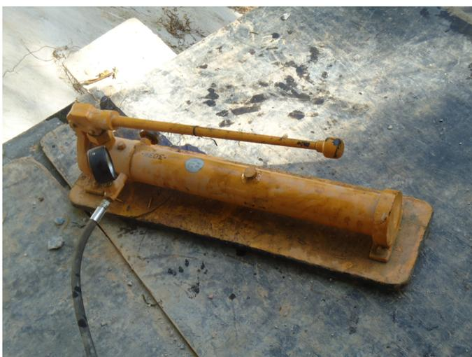
**Figura 67:** Detalhe da bomba para aplicação das cargas e do manômetro para sua leitura
