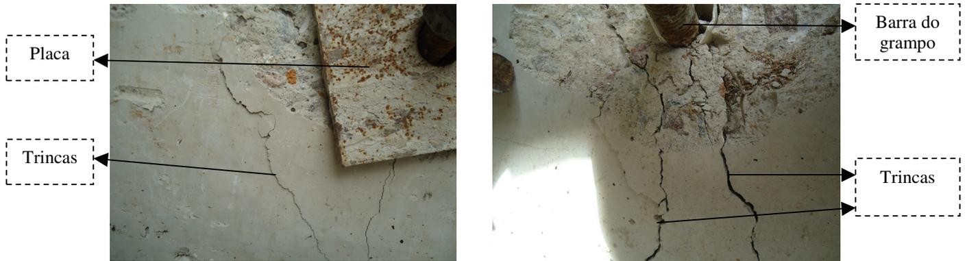
**Figuras 68 e 69:** Trincas geradas no concreto após a realização do ensaio
