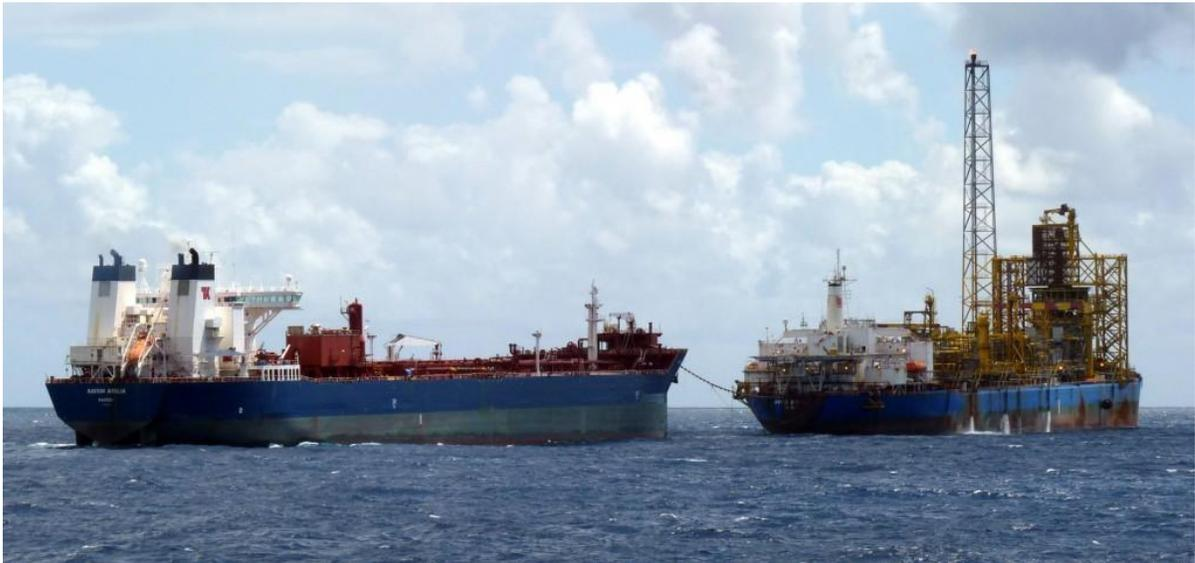
Figura 2 – Um moderno Shuttle tanker (navio aliviador) fazendo alívio de um FPSO no Brasil.
