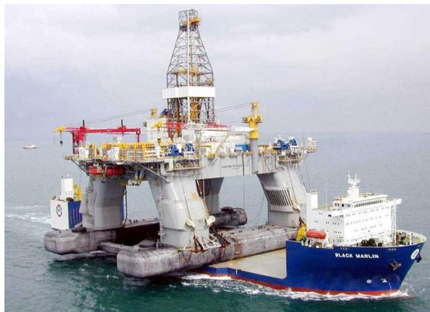
Figura 7 – Plataforma Semi-submersível Deep Horizon sendo levada até o local de operação.
