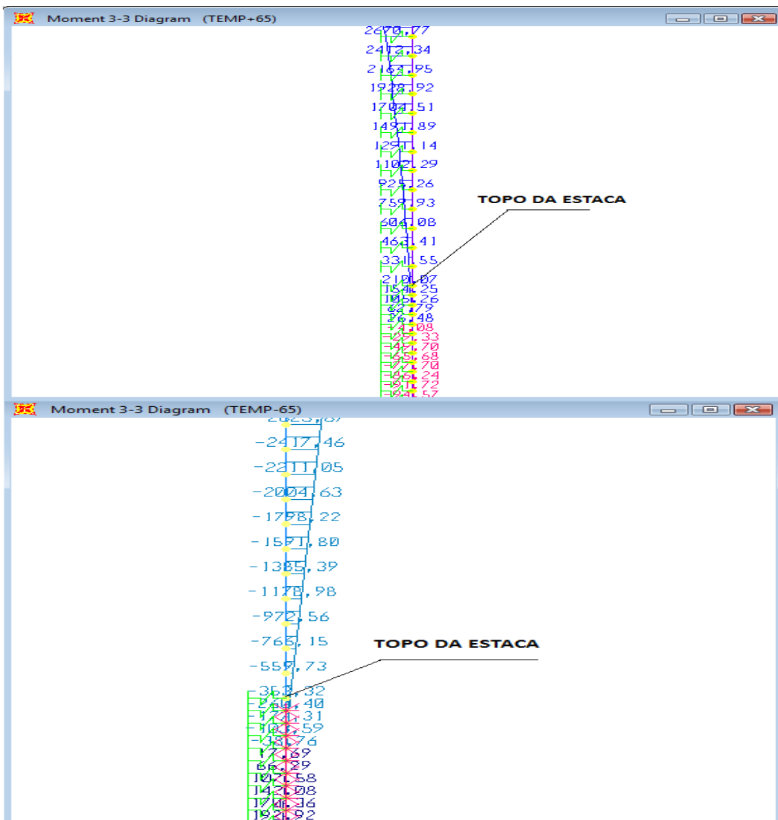
Figura 56 – Diagrama de momentos na cabeça da estaca para variação de temperatura de 65°C, comparação entre variação positiva e negativa de temperatura.
