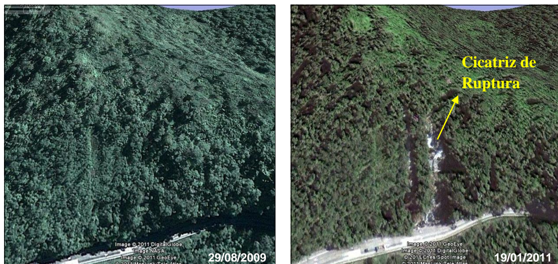
Figura 3.6 - Imagens de satélite antes e depois da ruptura.
