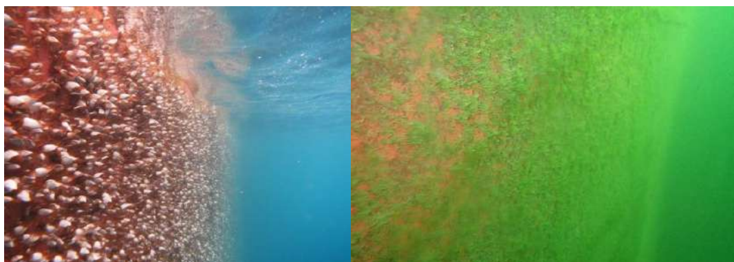
Figura 1 – Casco com presença de craca e limo.
