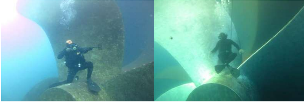
Figura 3 – Propulsor antes e depois de limpeza e polimento.
