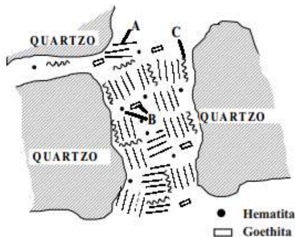
Figura 4.1 - Arranjos de partículas de quartzo, caulinita (A), óxidos de Fe (B) e matéria orgânica (C) em agregado de Latossolo caulinitico. Fonte: FERREIRA et al. (1999)
