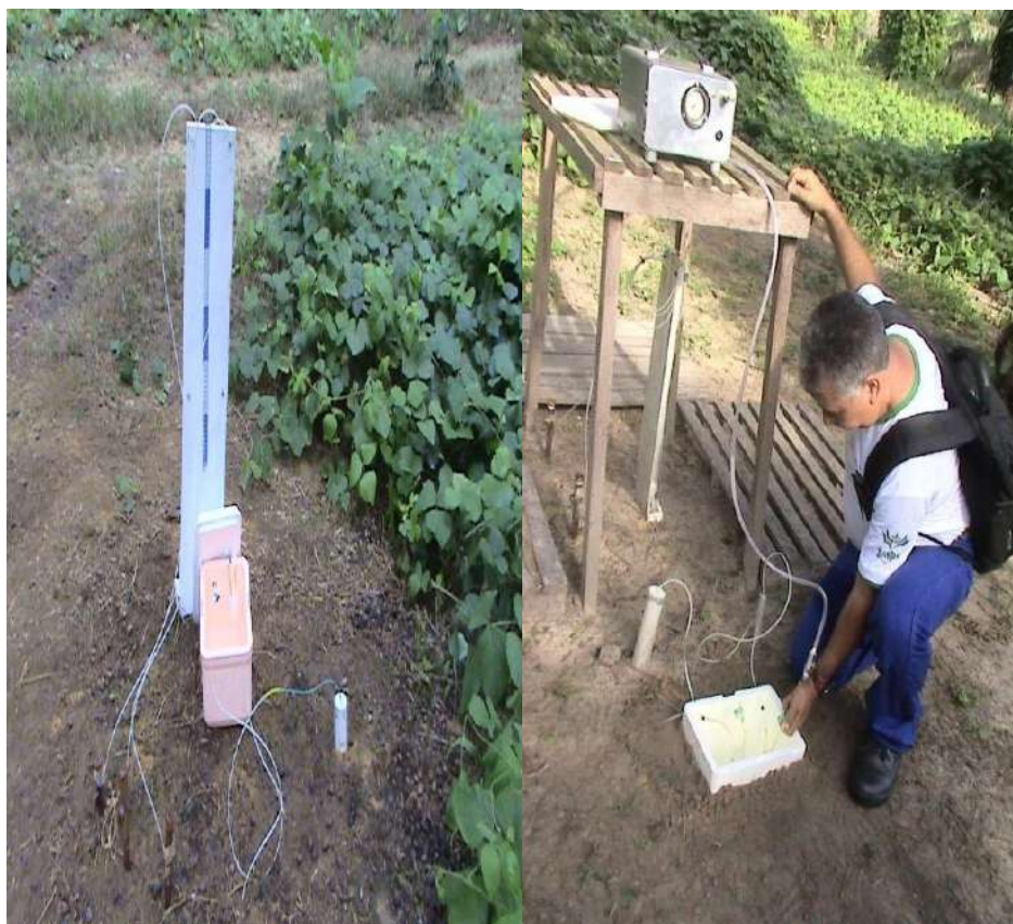
Figura 3.5 – Extratores de cápsula porosa para amostragem da solução do solo (Foto: Wenceslau Teixeira).
