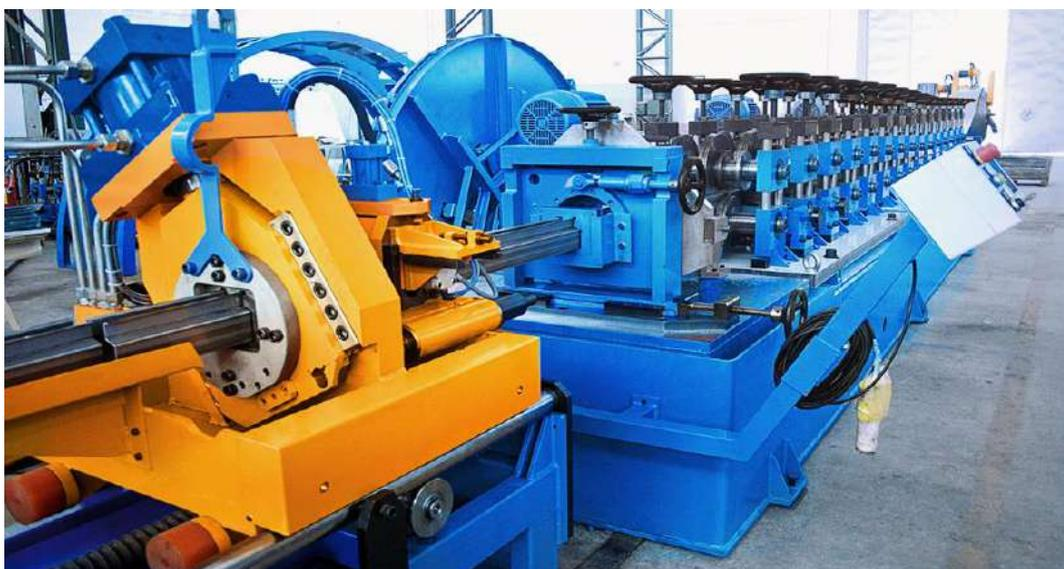
Figura 1.1 – Fabricação de perfis formados a frio empregando perfiladeira (ZIKELI)
