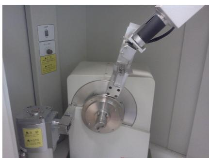
Figura 3.16: Equipamento SHIMADZU XRD-6000 para realização da difração de raios-x.
