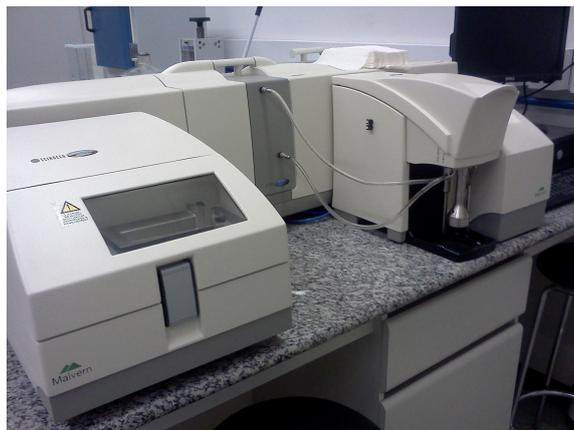
**Figura 3.6:** analisador de tamanho de partícula Zetasizer, Marca Malvern Instruments / modelo ZEN3600.
