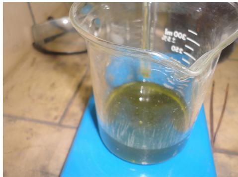
**Figura 3.20:** Solução passante através do filtro contendo partículas finas de B<sub>4</sub>C que não ficaram retidas no filtro de papel.
