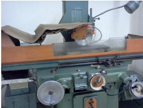
**Figura 3.14:** Retífica utilizada na preparação superficial das amostras.
