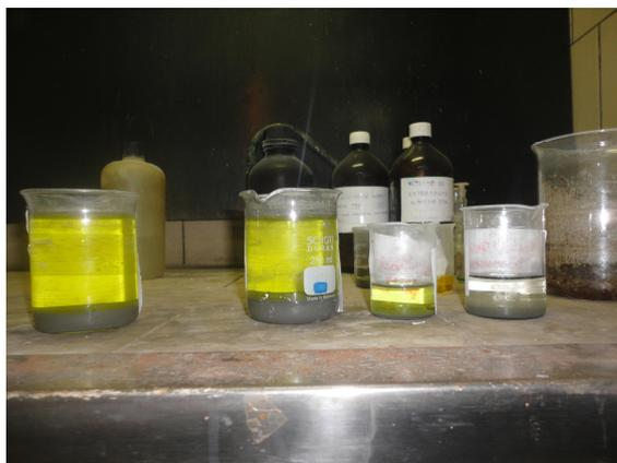
**Figura 3.17:** Os 3 bechers da esquerda exibem o pó contaminado na moagem, já decantado, enquanto o bécher da direita exhibe o pó sem moagem, desprovido de contaminação.
