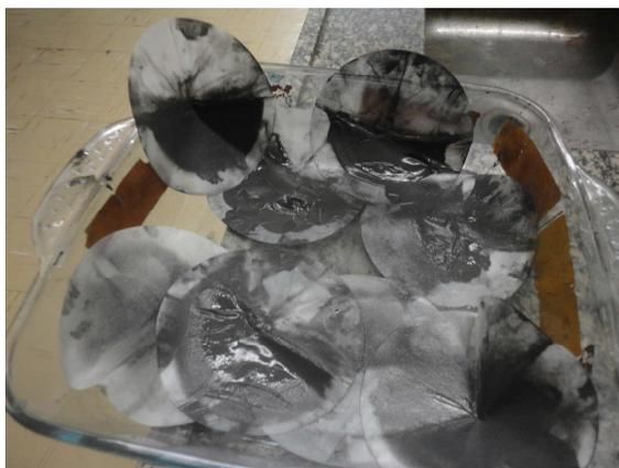
**Figura 3.21:** Filtros com pó retido e ainda úmido (com HCl: H<sub>2</sub>O)
