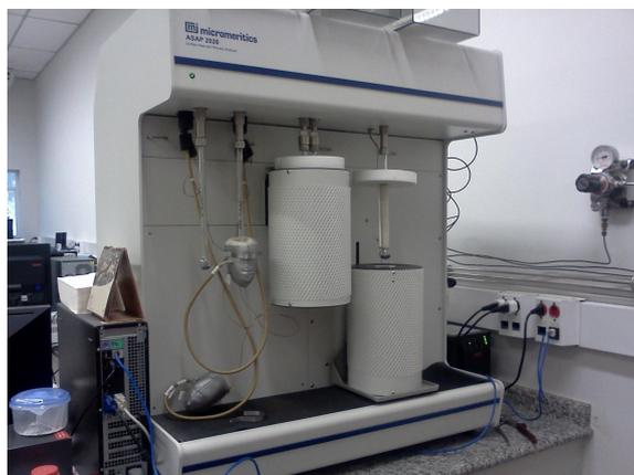
**Figura 3.7:** Analisador de área BET, marca Micromeritics, modelo Asap 2020.
