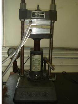
**Figura 3.8:** Prensa hidráulica uniaxial CARVER/ Modelo C S/N 41000-915.
