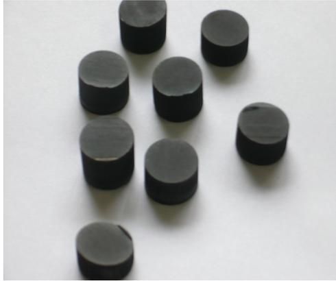
**Figura 3.13:** Figura: pastilhas após o corte – base e topo ainda não paralelos.
