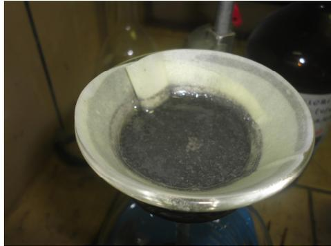
**Figura 3.19:** Solução sendo filtrada e o pó retido no filtro.
