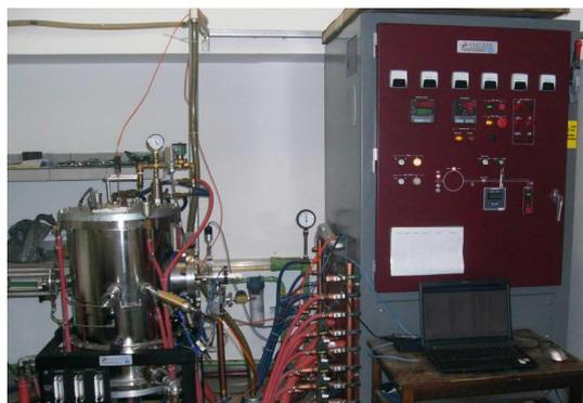
**Figura 3.10:** O forno de sinterização da Centorr VI.
