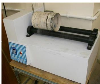
**Figura 3.3:** Moinho de rolos MS Mistura / modelo MSM 620.
