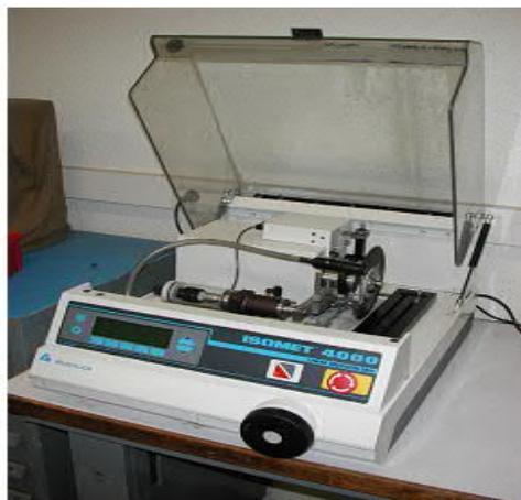
**Figura 3.12:** Máquina de corte ISOMET 4000.
