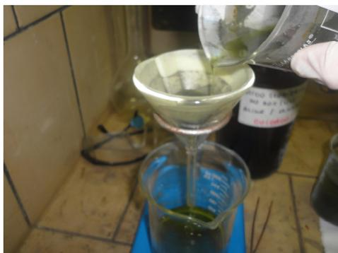
**Figura 3.18:** Solução sendo despejada no funil revestido com filtro.
